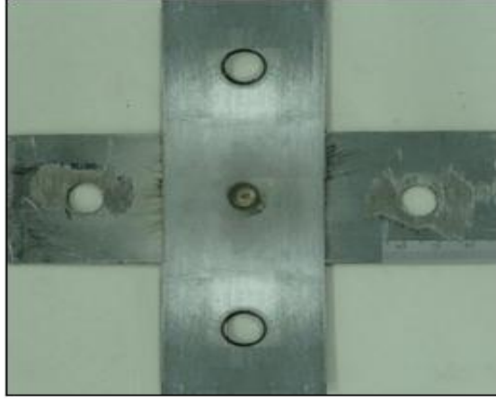
Şekil 3.11. Çapraz-çekme testi için birleştirilen deney numunesi.
