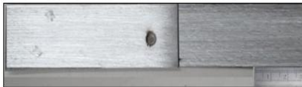
Şekil 3.10. Çekme-makaslama testi için birleştirilen deney numunesi.
