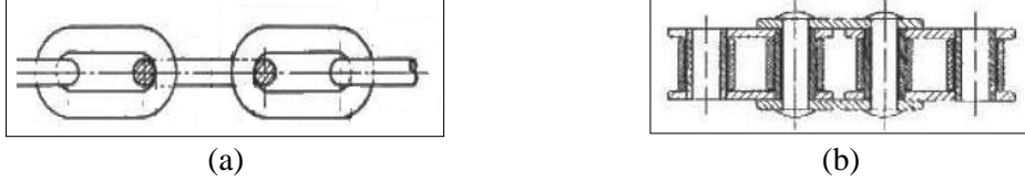
Şekil 2.5. Konveyörlerde kullanılan zincirler a) yuvarlak baklalı ve b) mafsallı.
