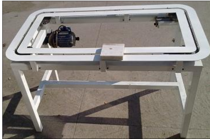
Şekil 3.3. İmal edilen sürükleyen zincir paletli konveyör.
