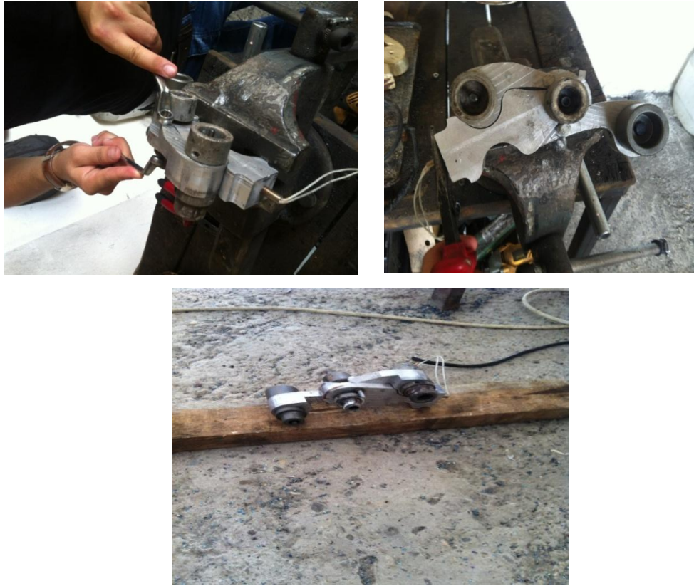
Şekil 3.5. Makinenin dökme kalıp alüminyum ile imalatı.
