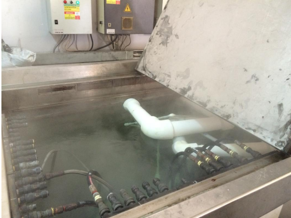
Şekil 4.14. Malzemelerin basınç havuzundan çıkartılması.
