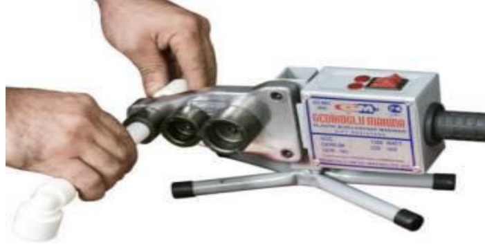
Şekil 3.1. Standart boru kaynağı.
