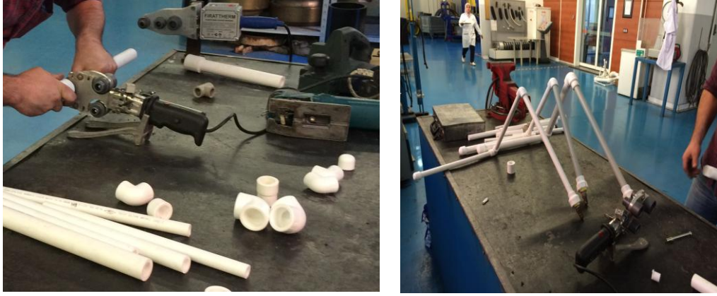
Şekil 4.8. 20 mm - 25 mm - 32 mm borularının birleştirilmesi.
