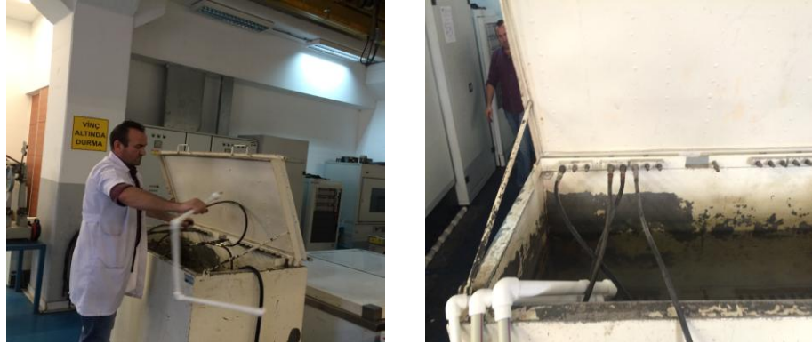
Şekil 4.9. 20 mm -25 mm - 32 mm borularının makineye bağlanması ve basınç havuzuna atılması.
