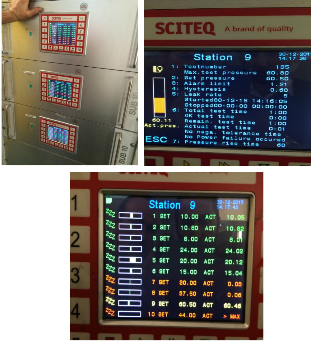
Şekil 4.10. 60 bar basınçta malzemelerin kaynak süre ve basınç ölçüm değerleri.
