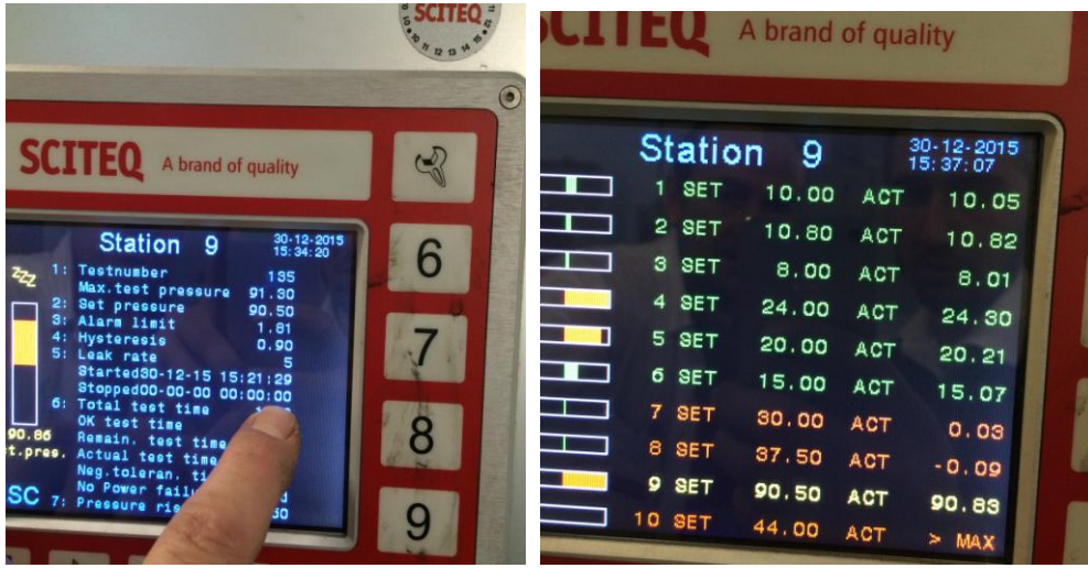
Şekil 4.12. 90 bar'da basınç set değerleri.
