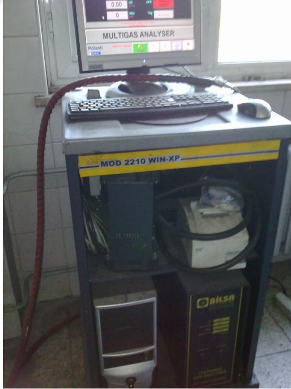
Şekil 6.5. Emisyon ölçüm cihazı.
