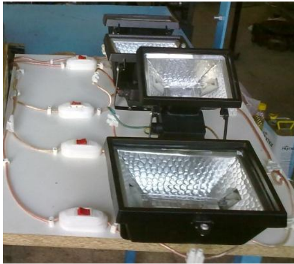
Şekil 6.4. Elektriksel yükleyici lamba panosu.
