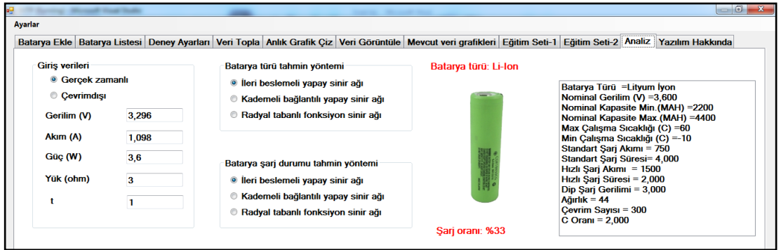
Şekil 6.48. Kullanıcı arayüzü ile gerçek zamanlı batarya türü ve ŞD tahmini.
