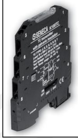
Şekil 5.12. K109TC sıcaklık dönüştürücü.
