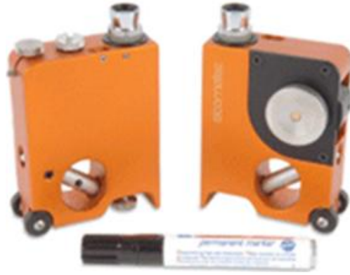
Şekil 3.2. Optik özellikli vernik ve boya katman kalınlığı ölçüm cihazı.
