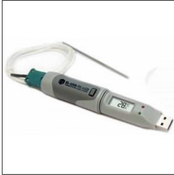
Şekil 5.12. Lascar EL-USB-TC-LCD Termokupl.
