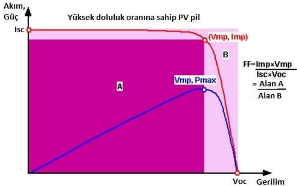
Şekil 3.15. Doluluk Faktörü (FF)'nin grafiksel olarak gösterimi (A/B) [53].
