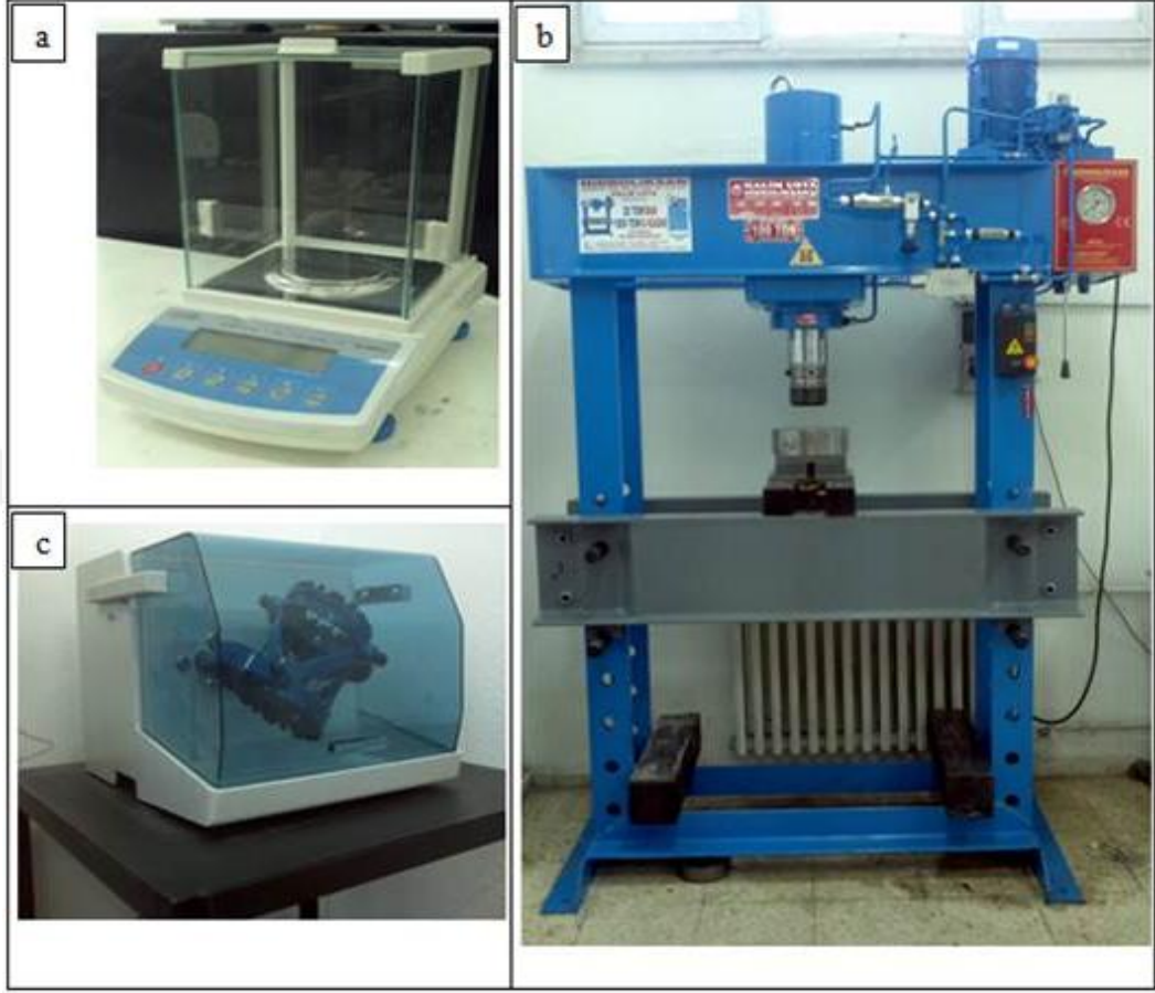
Şekil 5.2. Deneysel çalışmalarda kullanılan a) hassas terazi, b) hidrolik pres ve c) turbula cihazı görüntüleri.
