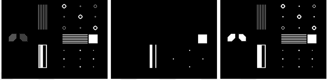
Şekil 5.11. Orijinal görüntü (solda), açma yapılan görüntü (ortada), kapama yapılan görüntü (sağda) [109].
