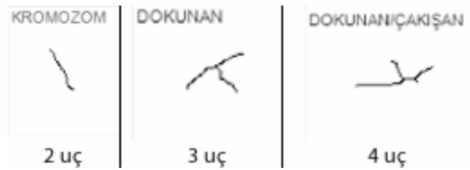
Şekil 6.39. Uç analizi sonrası oluşan sınıflandırma.
