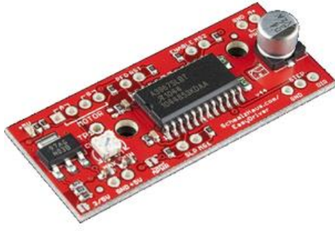
Şekil 6.6. Easydriver adım motoru sürücüsü (solda), A4988 adım motoru sürücüsü (sağda).
