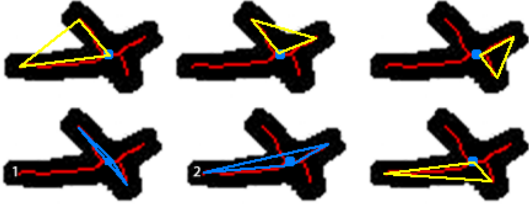
Şekil 6.41. Uç sayısına göre çizilen üçgenler (mavi renkli üçgenler içerisinde 1 numaralı olan en geniş açığa sahiptir ve uçları ilk parçayı oluşturur, 2 numaralı üçgen ikinci en geniş açığa sahip üçgendir ve uçları ikinci parçayı oluşturur).
