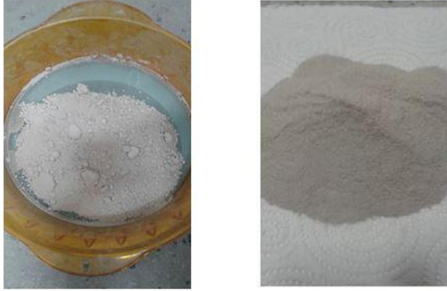
Şekil 5.26. Kil malzeme eleme işlemi ve kil malzemenin toz hali.
