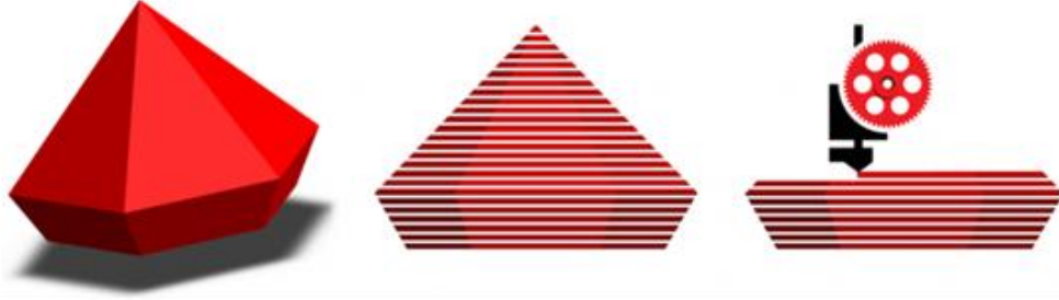
Şekil 1.3. Baskı işlemi aşamaları [6].
