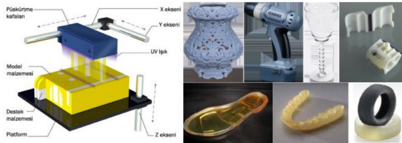
Şekil 3.5. Polyjet teknolojinin çalışma prensibi ve üretilen parçalar [39].
