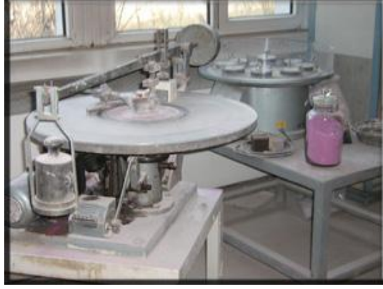
Şekil 2.5. Seramik malzemeler için kullanılan aşınma deneyi cihazı [20].
