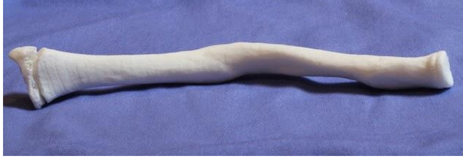
Şekil 2.10. Sinterleme yöntemi ile seramik tozundan kemik üretimi [25].
