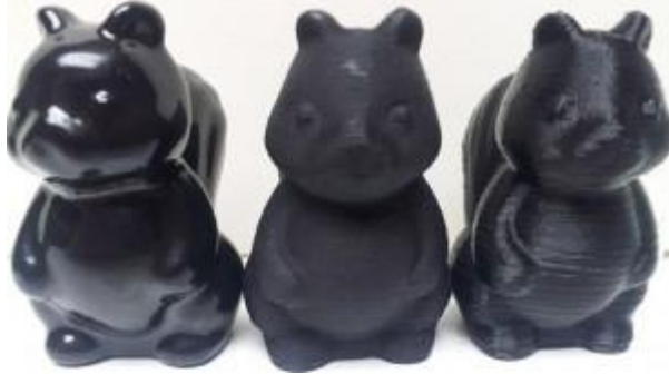
Şekil 4.1. ABS malzemesi baskısı ve son işlemleri [40].
