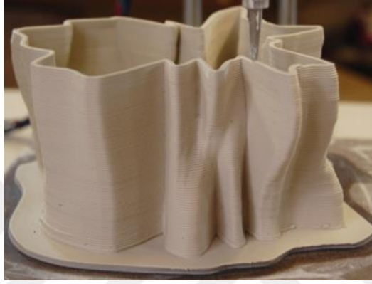
Şekil 2.6. Jonattan Keep icebergs, harç yığıma (fdm) baskı süreci [22].
