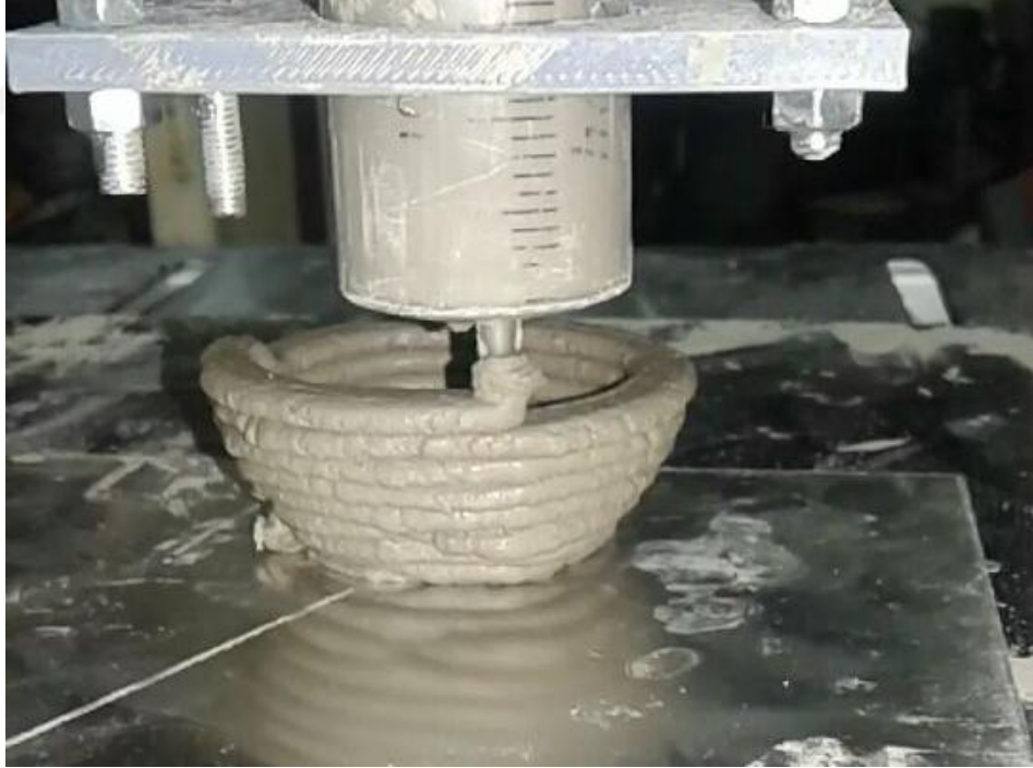
Şekil Ek A.6. Silindirik bir parçaya sahip numunenin yazdırma işlemindeki görüntüsü.
