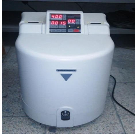
Şekil 6.1. Elementel tozların karıştırılmasında kullanılan mekanik alaşımlama/öğütme cihazının görüntüsü.
