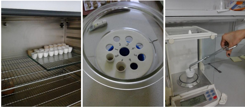
Şekil 3.46. Kızdırma kaybı analizinin porselen krozellerle, 105 derecede etüvde ısıtılması ve soğuduktan sonra bünyesinde bulunan madde miktarlarının belirlenmesi.
