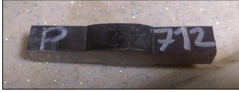
Şekil 5.8. Sertlik ölçümünde kullanılan numune örneği.
