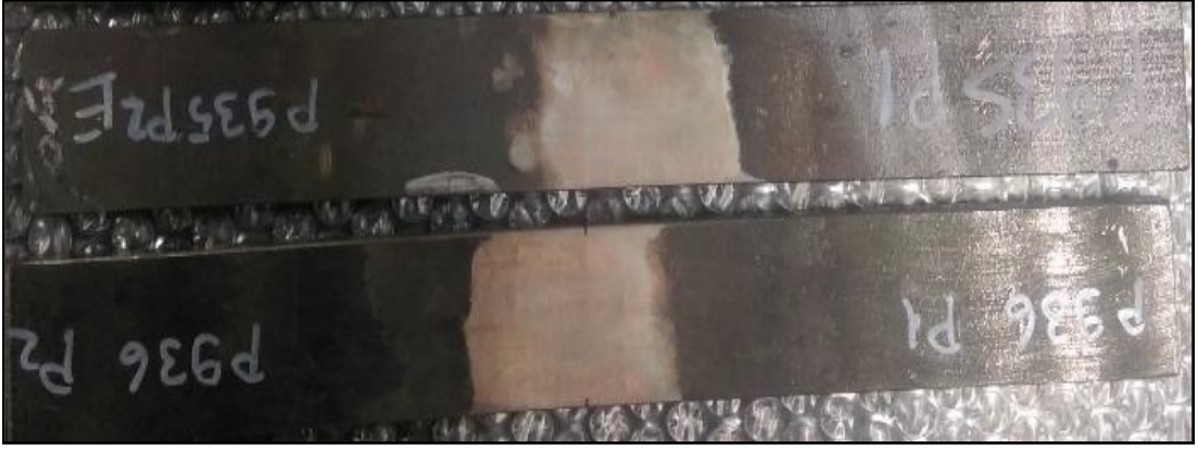
Şekil 5.12. Eğme testi için hazırlanan numune görüntüleri.
