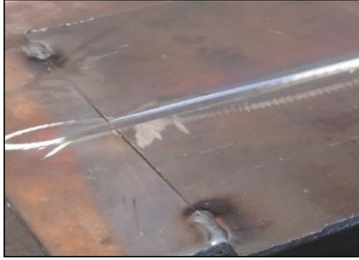
Şekil 5.3. Parçaların puntalanarak kaynağa hazırlanması.
