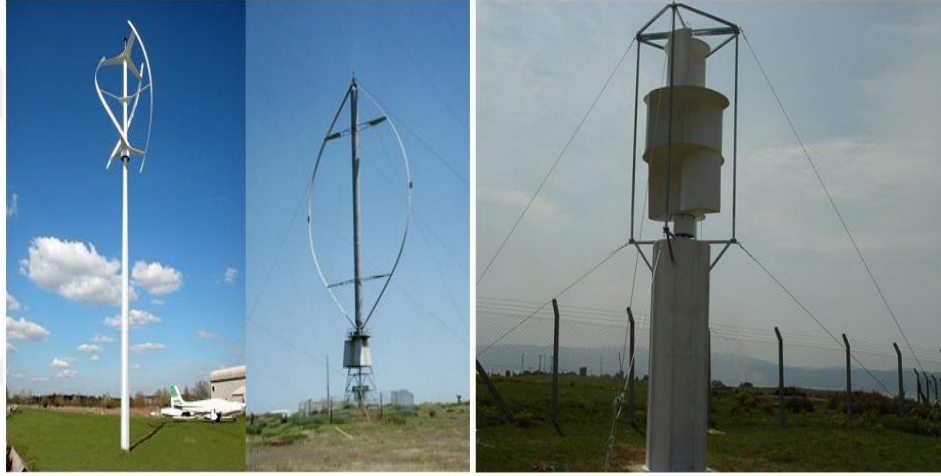
Şekil 3.6. Darrieus ve Savonius tipi rüzgâr türbinleri [28].
