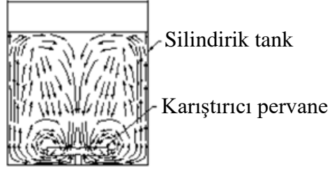
Şekil 6.7. Katı partiküllerin tank içindeki akış formuna ait şematik görüntü [65].
