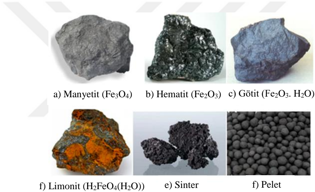
Şekil 2.1. Yüksek fırınlarda kullanılan demir cevherleri.
