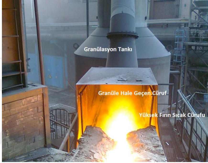
Şekil 6.1. KARDEMİR A.Ş 1 no'lu yüksek fırını granüle cüruf elde edilme anı görüntüsü.
