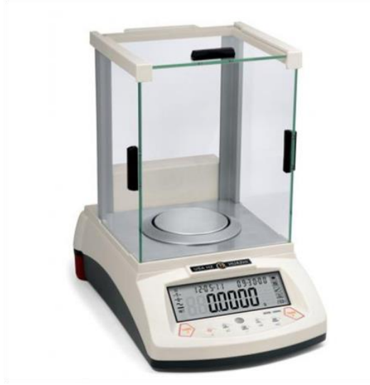
Şekil 6.6. DENSI HZY 320A model hassas teraziye ait görüntü.
