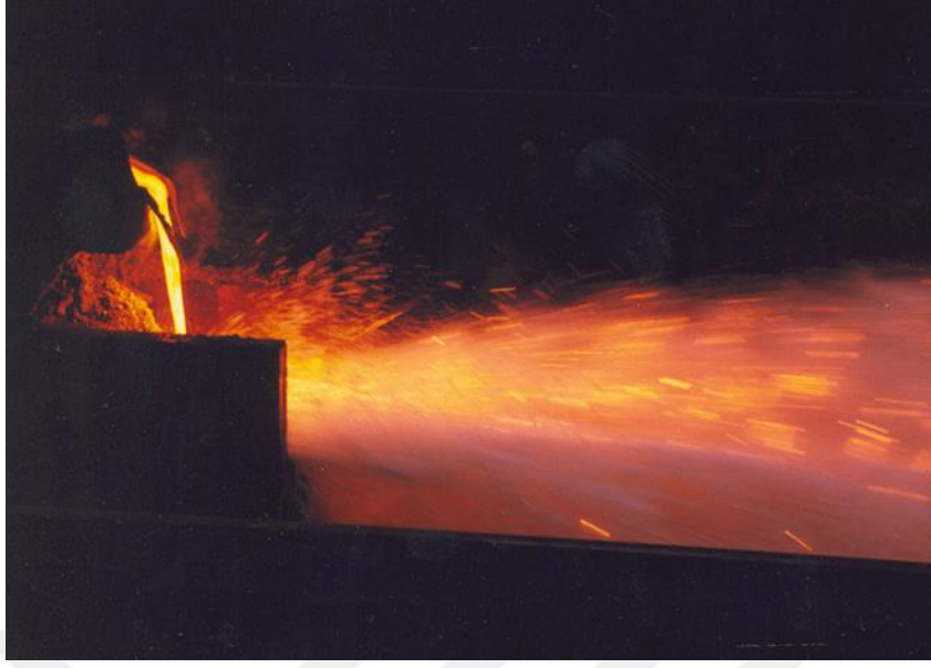
Şekil 6.2. Yüksek fırın sıcak cürufunun granüle edilme anı görüntüsü.
