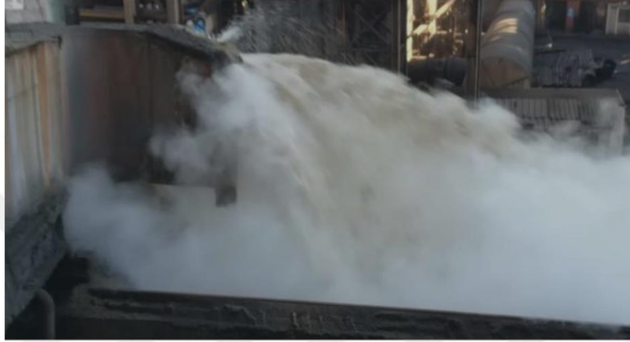
Şekil 2.9. Yüksek fırın cürufunun granüle edilme anı görüntüsü.
