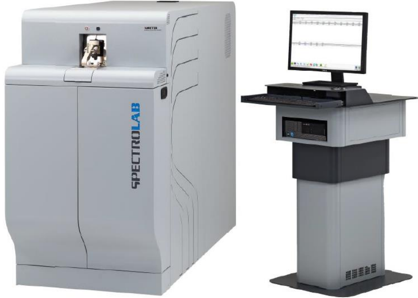
Şekil 6.11. Deney numunelerinin kimyasal kompozisyonlarının belirlenmesinde kullanılan spektrometre cihazına ait görüntü.
