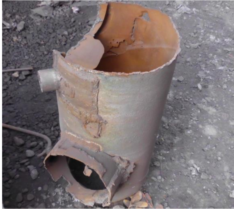
Şekil 6.5. Aşınmaya maruz kalmış granüle cüruf taşıma hattı borusu görüntüsü.
