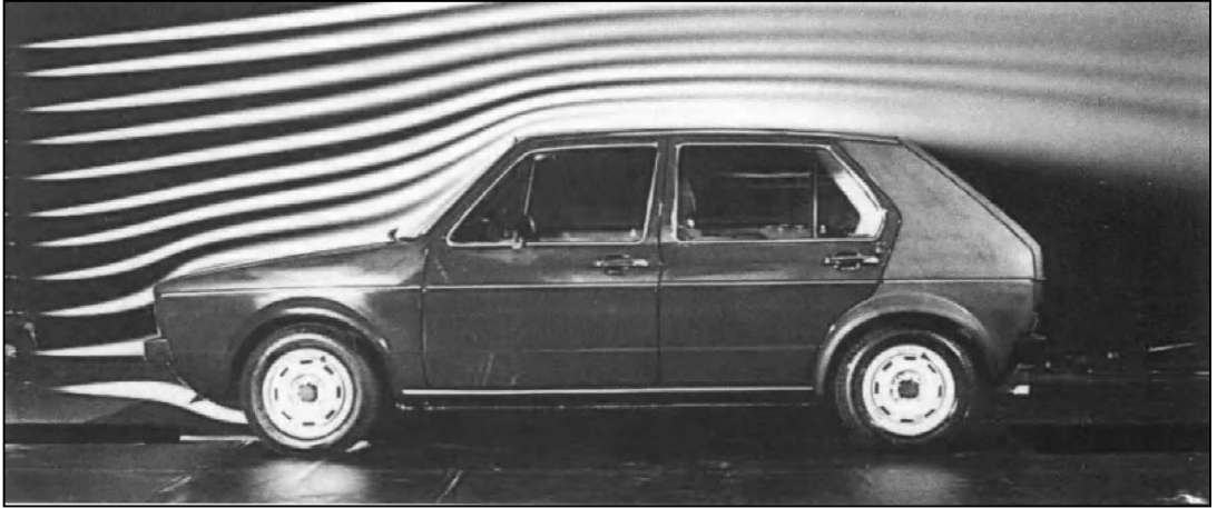
Şekil 2.2. Volkswagen AG aracının, rüzgâr tüneline tam boyutlu bir araç için orta kesitte hava akım çizgileri [2].
