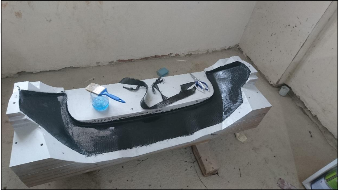
Şekil 3.42. İlk kat 245gr/m 2 fiber kumaş serimi.
