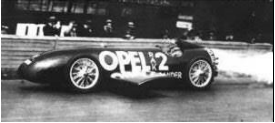
Şekil 2.9. Opel's RAK 2, yan kanatlar [16].
