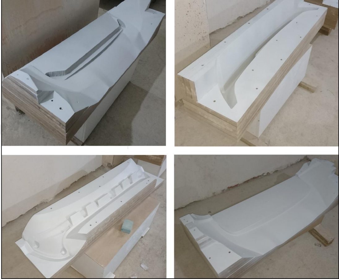
Şekil 3.41. Yüzey işlemleri bitirilen kalıp modelleri.
