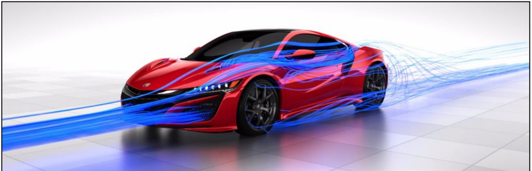
Şekil 2.3. Acura NSX'in lamine ve türbülans çizgileri [5].
