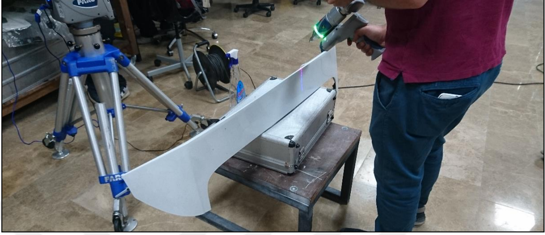
Şekil 3.1. FARO® Design ScanArm® ile mevcut spoilerin taranması.
