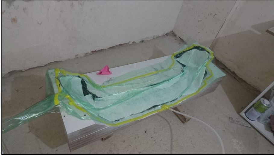
Şekil 3.43. Vakum torbalama ile parça üretimi.
