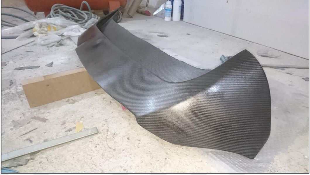
Şekil 3.46. Yüzey işlemleri biten spoyler.
