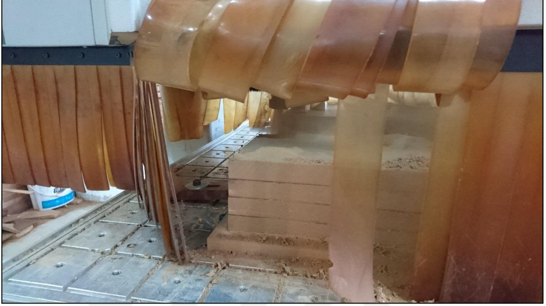
Şekil 3.39. CNC’de kalıp modellerinin işlenmesi.
