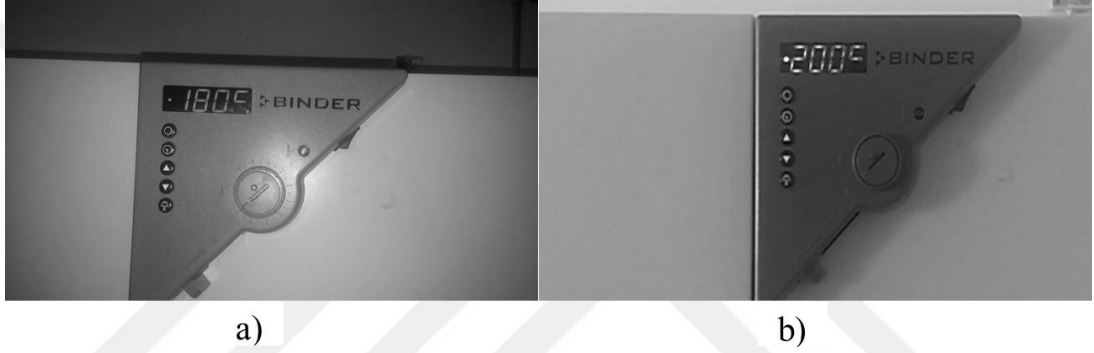
Şekil 4.13. Isıtma işlem sırasında fırın sıcaklık değerleri. a) Y1 için 180°C ve b) Y2 için 200°C.
