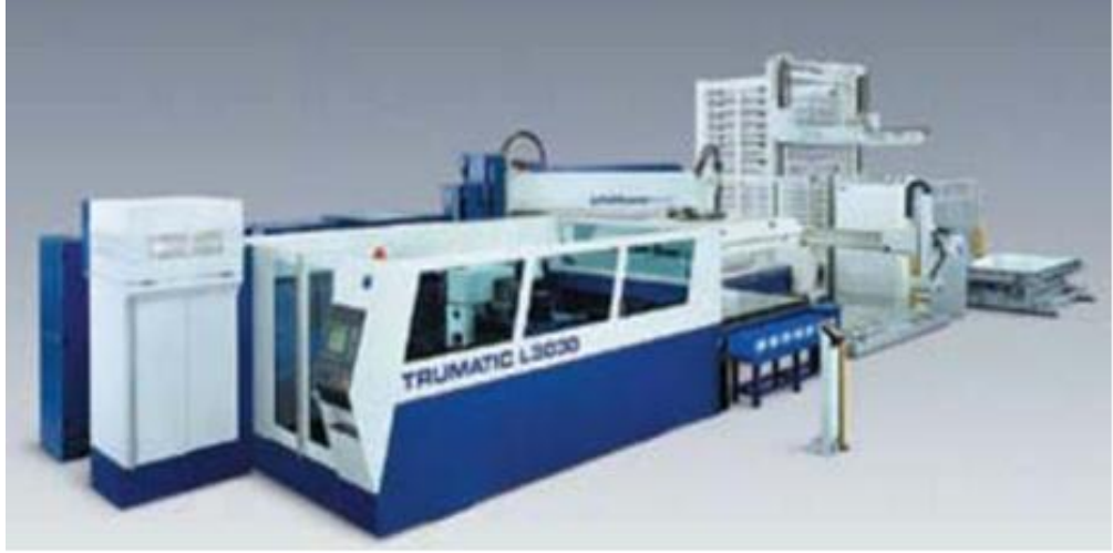
Şekil 4.5. Trumpf Trumatic L 3030 TLF 4000 Lazer kesim tezgâhı.
