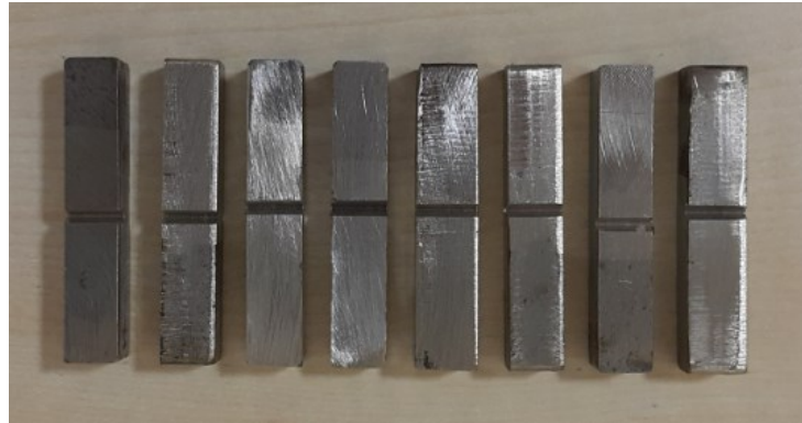
Şekil 3.12. TSE EN ISO 9016 standardına göre hazırlanan çentik darbe deneyi numuneleri
