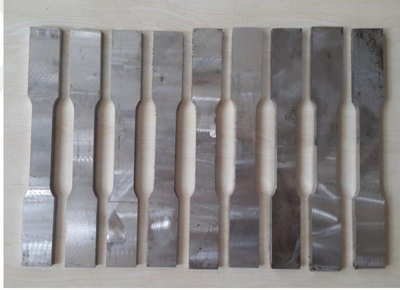
Şekil 3.10. TS EN 4136 standardına göre hazırlanmış çekme deneyi numuneleri.
