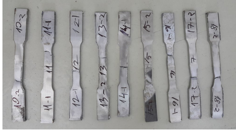
Şekil 4.12. AH36-AISI 316L çelik çifti birleştirmelerine ait çekme deneyi sonrası kopma görüntüleri.
