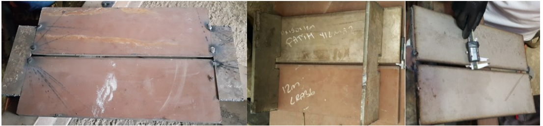
Şekil 3.3. AH36-AH36, AH36-AISI 316L ve AISI 316L-AISI 316L çelik birleştirmeleri için 450x300x12 mm parçaların hazırlanması.
