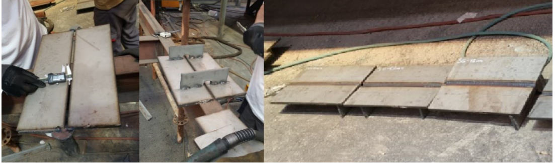
Şekil 3.7. AISI 316L-AISI 316L paslanmaz çelik çiftinin hazırlanması.
