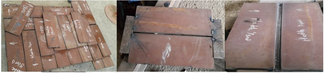
Şekil 3.5. AH36-AH36 çelik çifti birleşimlerinin hazırlanması.
