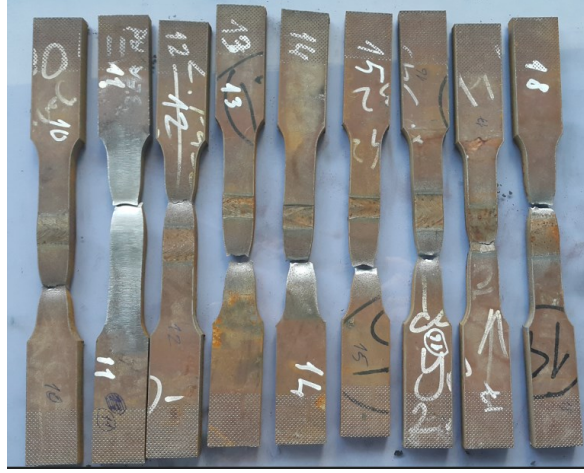
Şekil 4.10. AH36-AH36 çelik çifti birleştirme ait çekme deneyi sonrası kopma görüntüleri.
