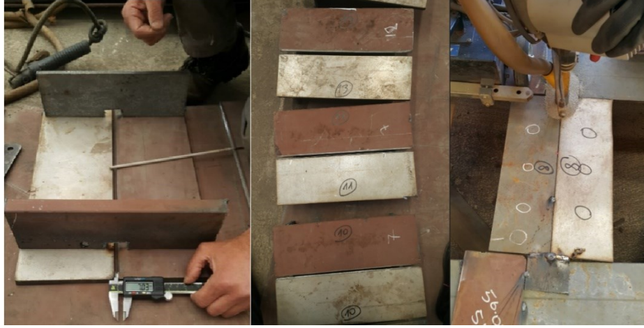
Şekil 3.6. AH36-AISI 316L çelik ve paslanmaz çelik çiftinin hazırlanması.
