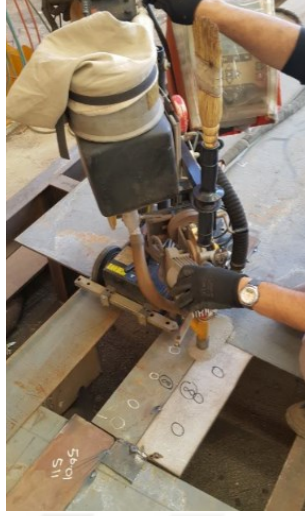
Şekil 3.1. Tozalıtı ark kaynak birleştirme için geliştirilen tutucu aparat.
