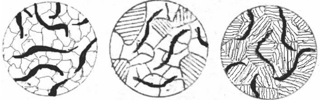
Şekil 3.10. Mikroyapılar (sırasıyla ferrit- ferrit ve perlit - perlit).
