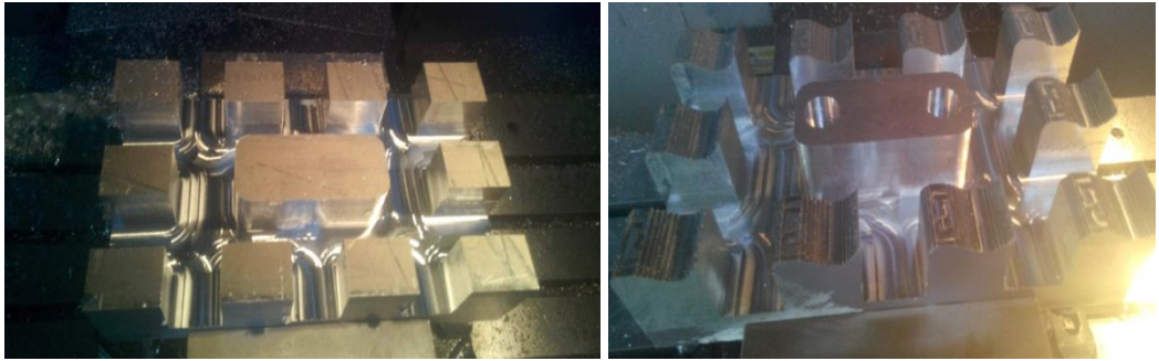
Şekil 3.6. Adalara ayrılan ve kaba işleme yapılan numuneler.
