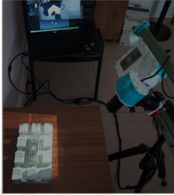
Şekil 3.13. 3B optik tarama ile işlenmiş yüzeylerin taranması.
