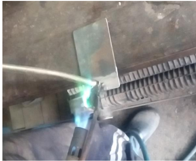
Şekil 3.4. Çeliği çubuk kalay ile kaplama işlemi.
