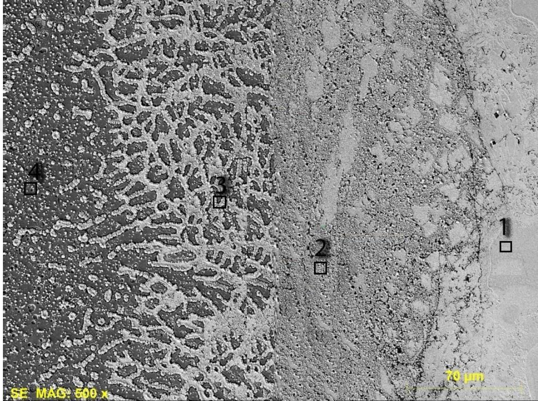
Őekil 4.7. TIG kaynađıyla birleŐtirilmiŐ 10 mm kalınlıktaki numunenin SEM grnts (500x).
