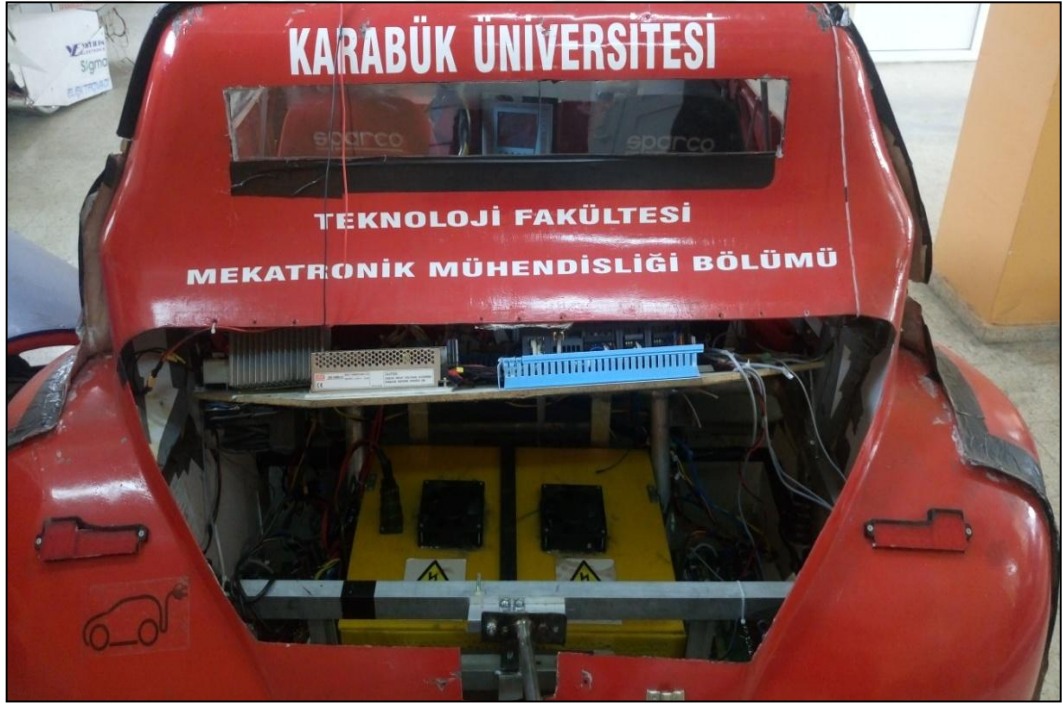
Şekil 4.41. Batarya yönetim sistemi kutusu BEA içine yerleşimi
