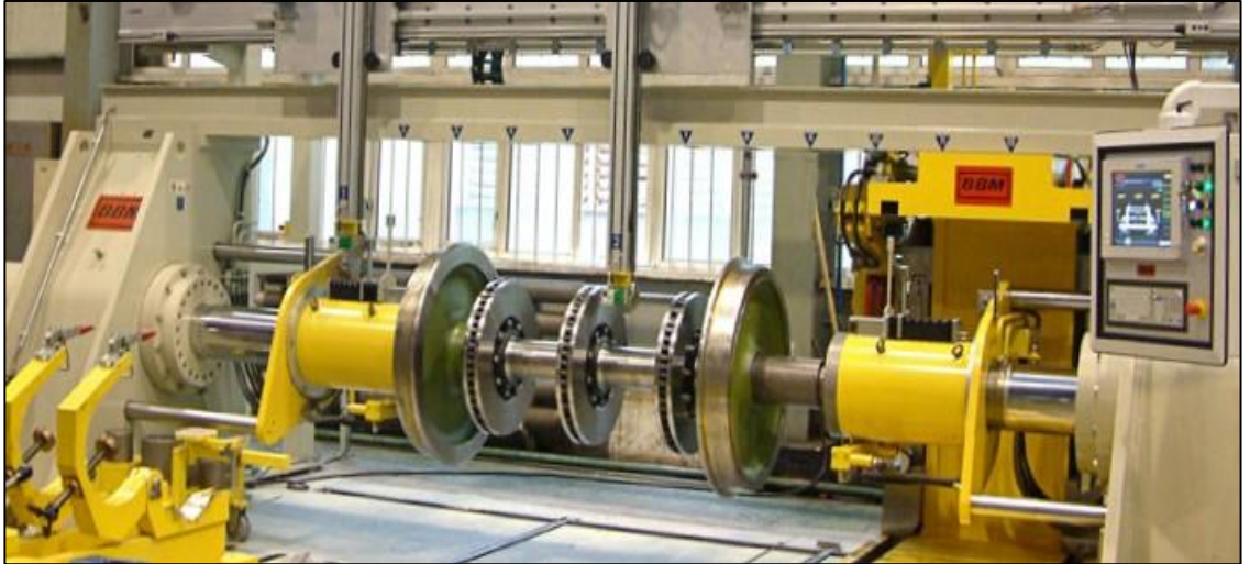
Şekil 5.3. Tekerlek pres makinası, teker-aks sıkı geçme uygulaması.
