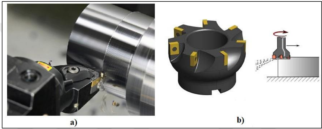
Şekil 4.2. Tek ve çok kesme ağızlı kesici takımlar, a) tek kesici uçlu takım, b) çok kesme kenarlı takım.
