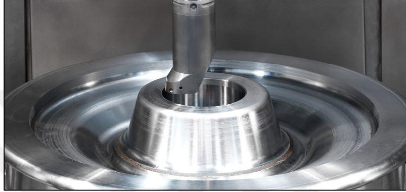
Şekil 3.12. Dik CNC torna tezgâhında tren tekerleđi göbeđinin işlenmesi.
