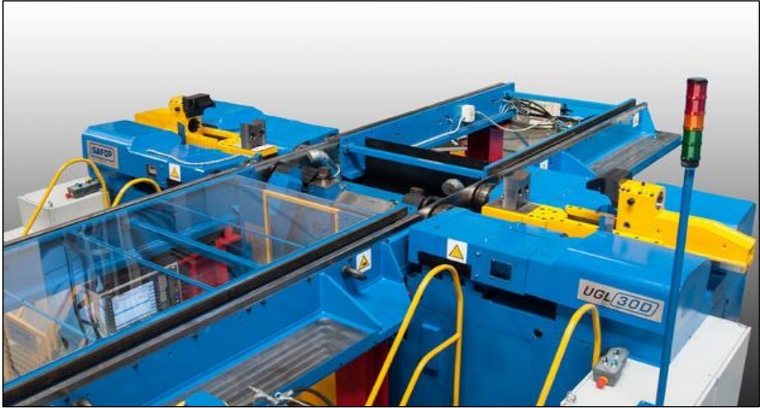
Şekil 3.14. SAFOP UGL 30D / Tek aksta bulunan iki tekerleğin bandaj tornalamasını yapabilen yeraltı tandem torna tezgâhı.
