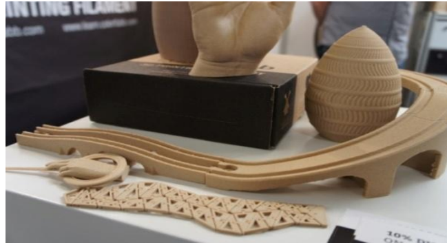
Şekil 3.23. Ahşap katkıli PLA modeli [34].
