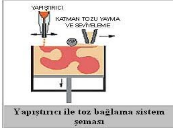
Şekil 3.6.Yapıştırıcı ile toz bağlama yönteminin çalışma prensibi [23].
