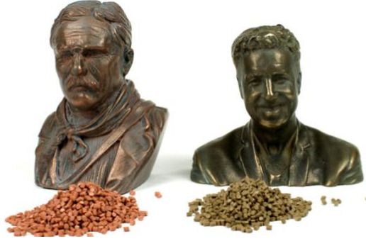
Şekil 3.24. Bakır ve Bronz katkılı PLA modeli [34].
