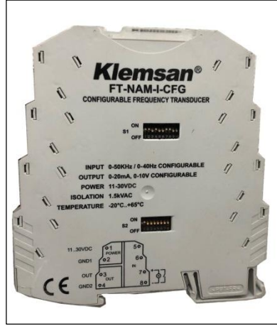
Şekil 5.26. Klemsan FT-NAM-I-CFG frekans gerilim çevirici.
