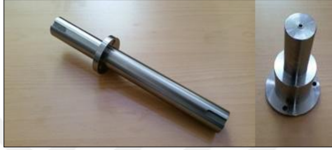
Şekil 5.19. TİEM ve volan bağlantı materyali.
