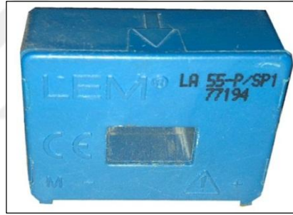
Şekil 5.23. LEM LA 55-P akım algılayıcı.
