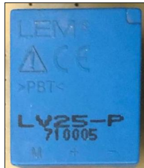
Şekil 5.24. LEM LV25-P gerilim algılayıcı.
