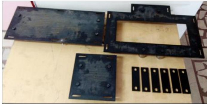
Şekil 5.20. TİEM, DAEM, volan tablaları ve yataklı rulman kirişleri.
