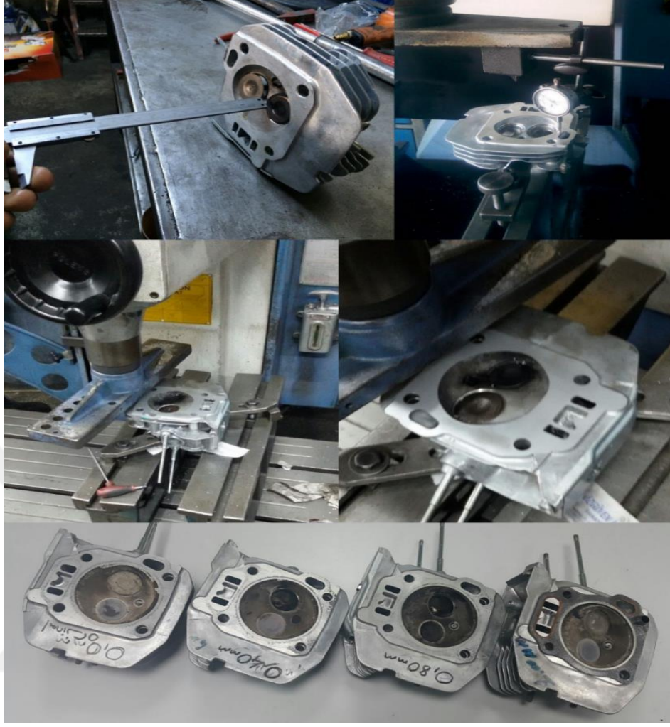
Şekil 6.12. Silindir kapağında talaş kaldırılması.
