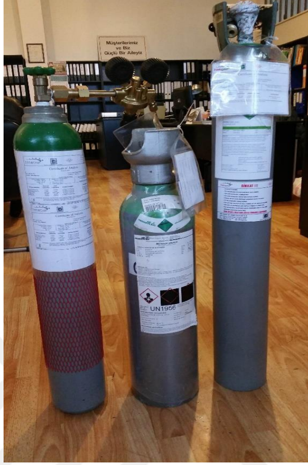
Şekil 6.15. Egzoz emisyon cihazının kalibrasyon tüpleri.
