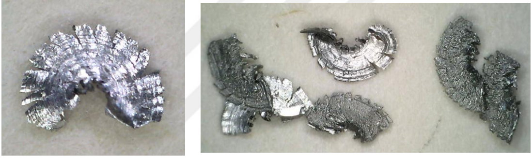
Şekil 7.27. Saf molibden talaşları.
