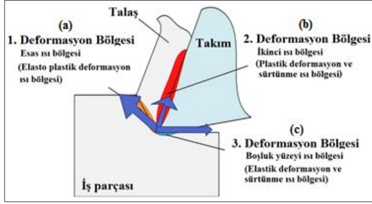
Şekil 3.5. Kesme bölgesi ısı oluşumu [46].
