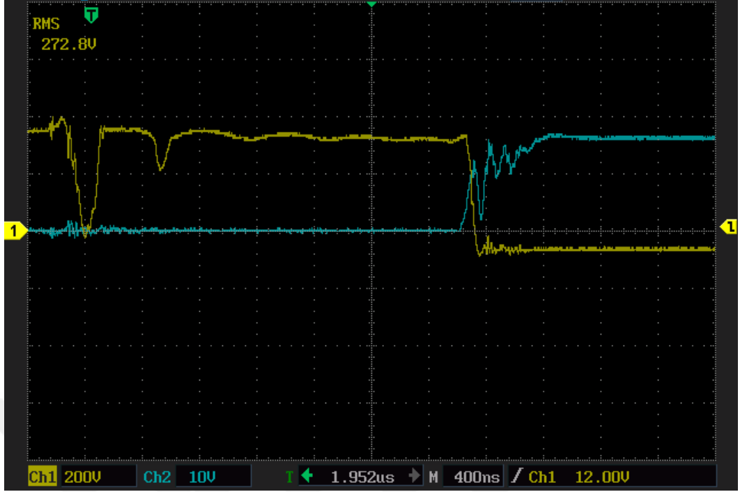
Şekil 5.10. H1 anahtarı G-S/D-S Sinyallerinin karşılaştırılması.
