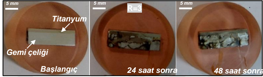
Şekil 6.11. Nötr tuz püskürtme testi sonrası numune görüntüleri.
