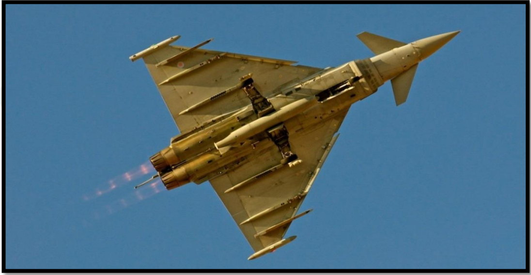
Şekil 4.12. Kanard uygulamalı Eurofighter Typhoon uçağı [16].
