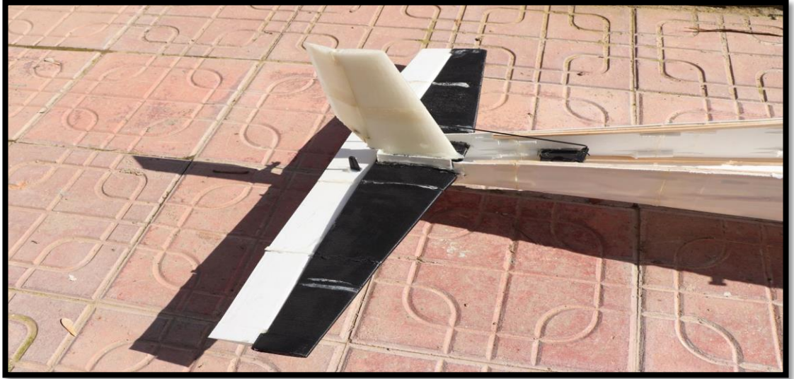
Şekil 5.10. Yatay stabilizer ve ona bağlı elevator ile dikey stabilizer ve ona bağlı rudder gösterimi.
