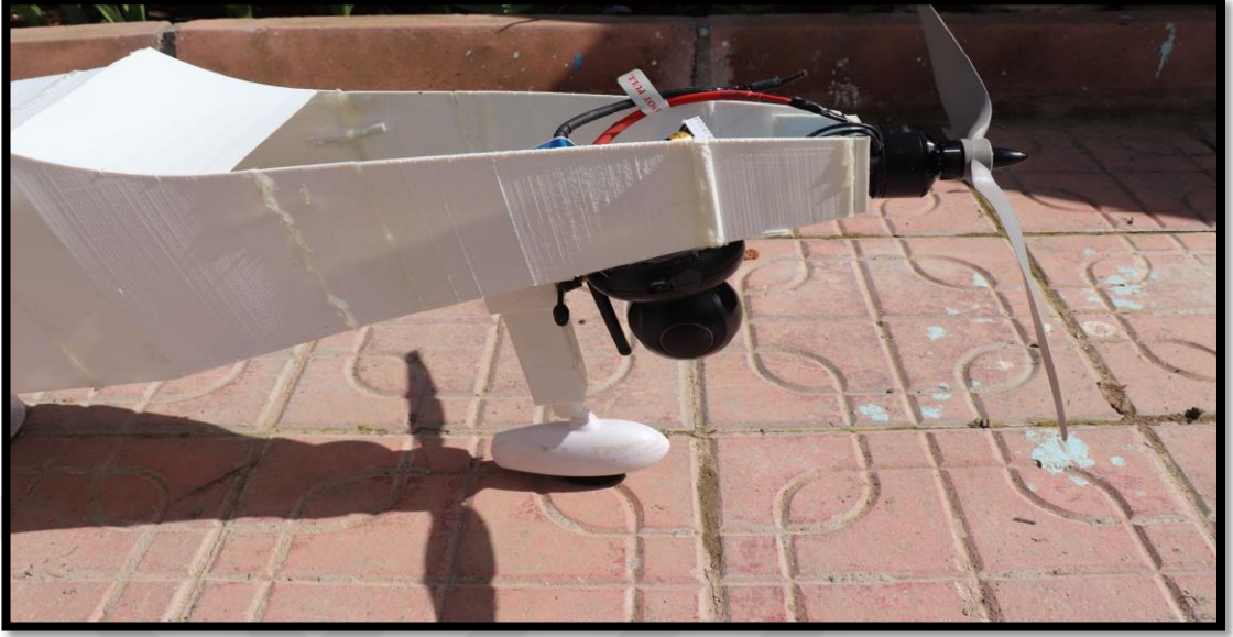
Şekil 5.11. İniş takımı, kamera, motor aksamları.
