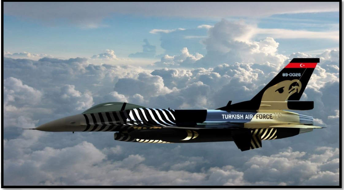
Şekil 4.14. Ortadan kanat tasarımına sahip olan F-16 [18].
