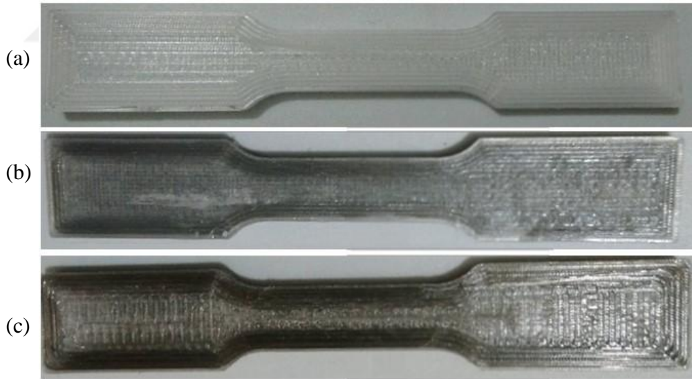
Şekil 3.15. Düz çizgi üretim deseni ile hazırlanan numuneler. a) sadece naylon, b) 304 kalite çelik tel, c) 316L kalite çelik tel kullanılarak basılmıştır.
