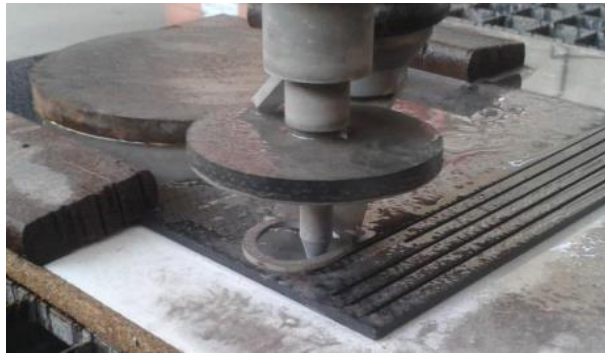
Şekil 3.5. CFRP kompozit malzemelerin ASJ ile kesilme anı görüntüsü [132].
