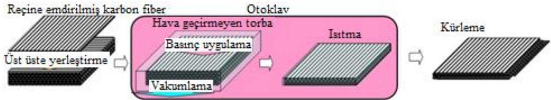
Şekil 2.7. Otoklav kalıplama yöntemi ile CFRP kompozit malzeme üretiminin görüntüsü [29].
