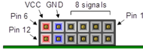
Şekil 6.3. Genesys2 geliştirme kartı üzerindeki PMOD konnektörlerinin pin bağlantısı.
