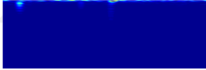
Şekil 4.8. AK47’ye ait ses kaydına 0 dB SNR değerinde insan konuşmalarına ait gürültü eklenmiş haline ait spektrogram görüntüsü.
