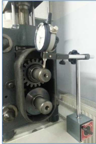
Şekil 4.6. Komparatör saati yardımıyla hassas paso ayarı.
