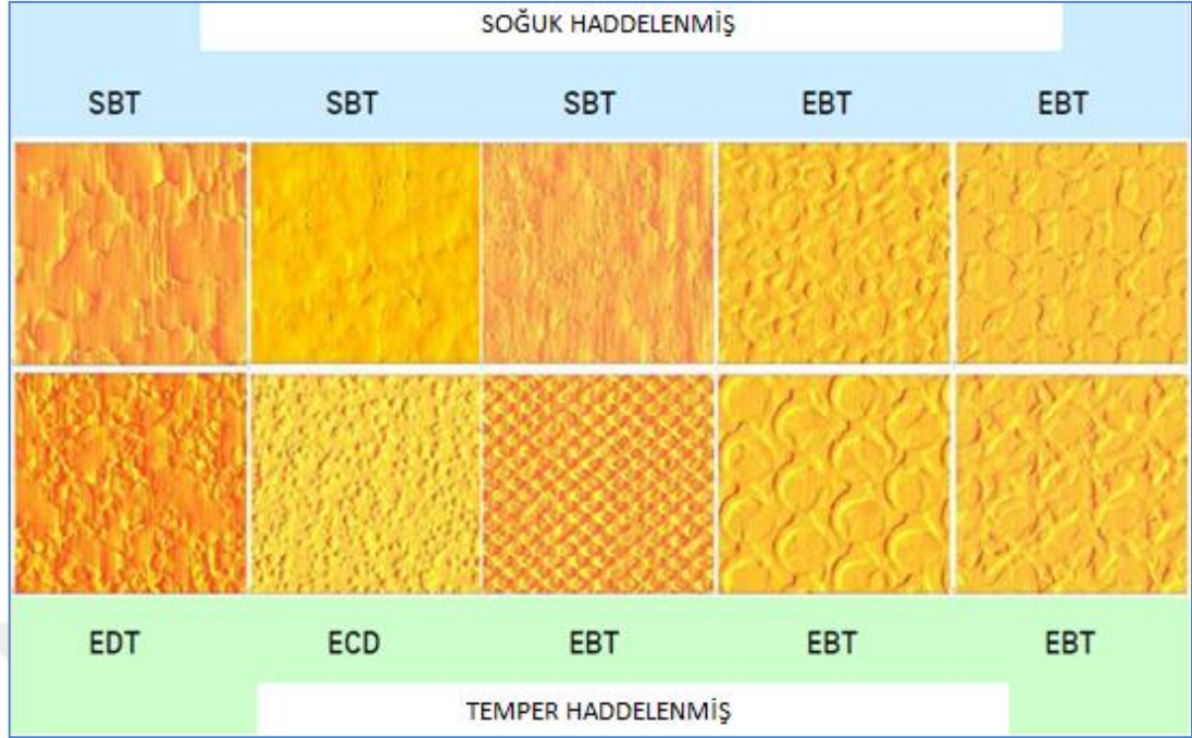
Şekil 2.23. Farklı yöntemlerle elde edilen malzeme yüzey topoğrafyaları [27,28].
