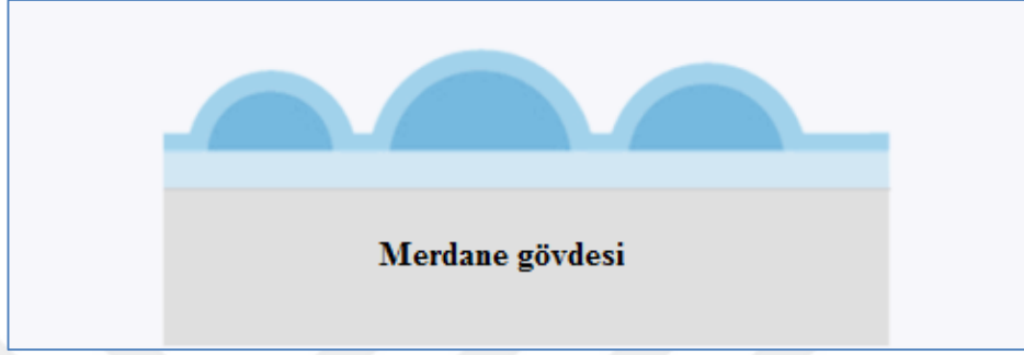
Şekil 2.29. Topokrom kaplama yüzeyi (damlacık görünümü) [29].
