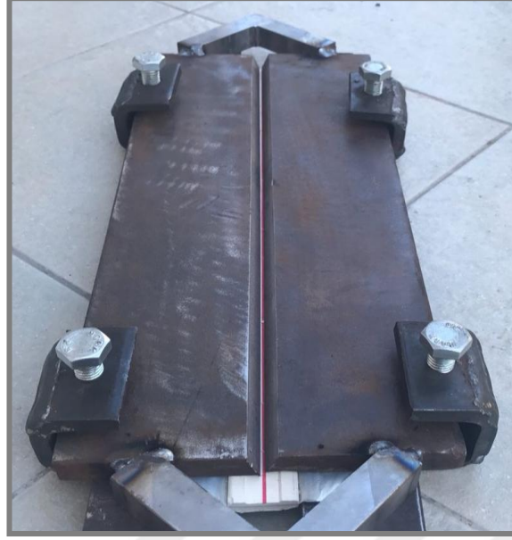
Şekil 6.3. Kaynak ağzı açılmış parçaların kaynak öncesi fikstürle sabitlenmesi.
