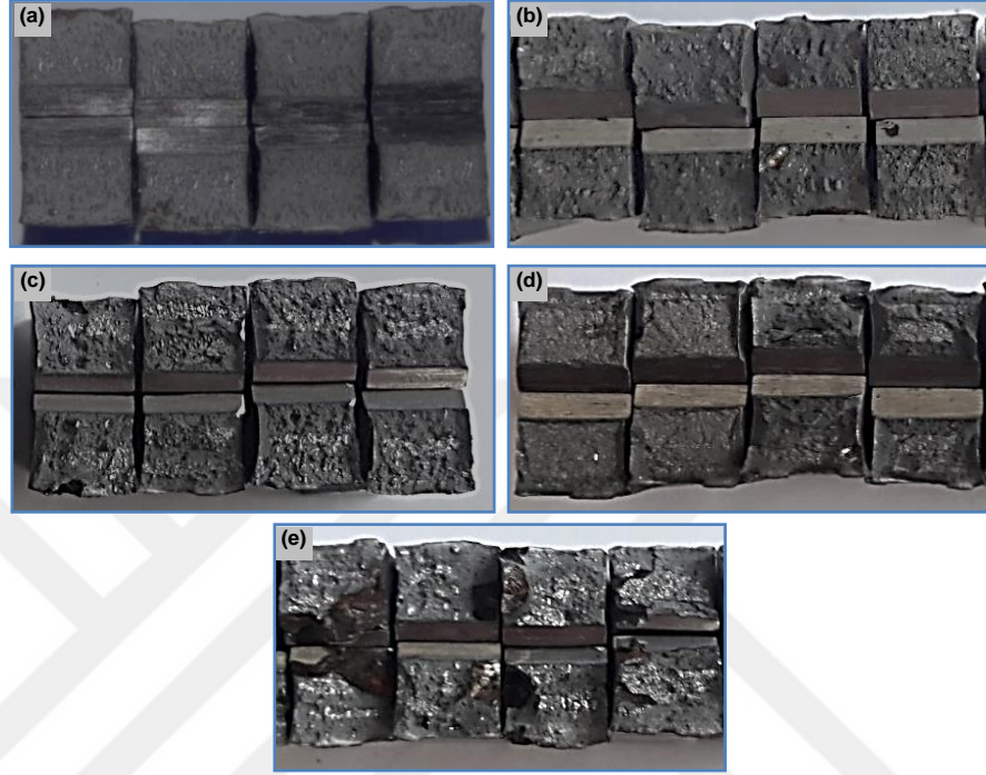
Şekil 7.9. Kaynak metali kırık yüzey görüntüleri a) atmosferik şartlar, b) 4 m, c) 8 m (E6013, d) 8 m (E7014), ve e) 16 m.
