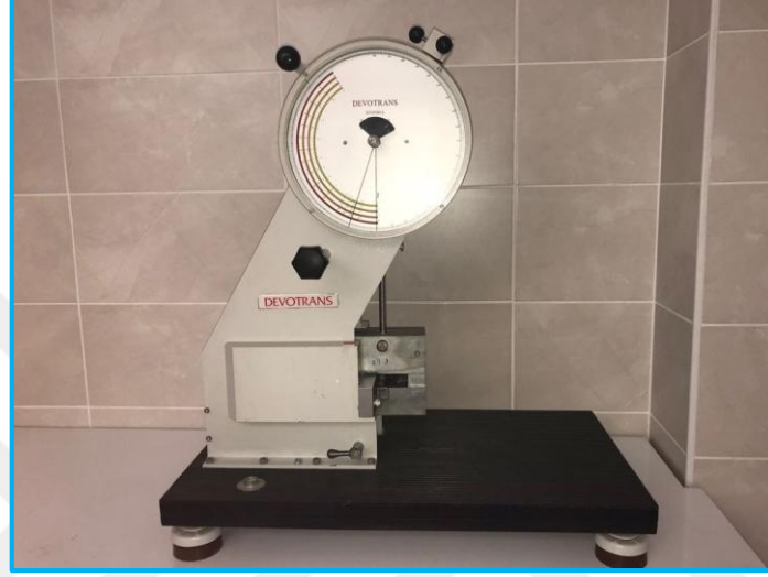
Şekil 5.12. Devontras marka çentik darbe cihazı.
