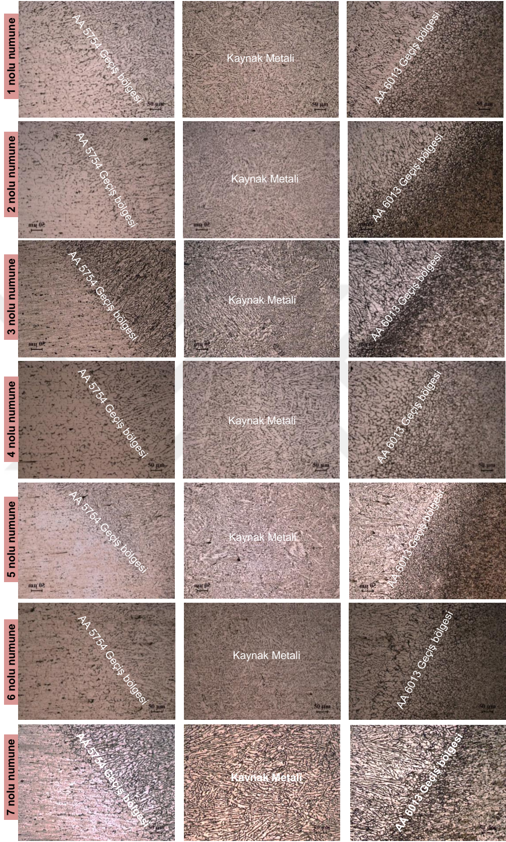
Şekil 6.24. Birleştirilmiş numunelerin kaynak metali ve geçiş bölgesi mikroyapıları.
