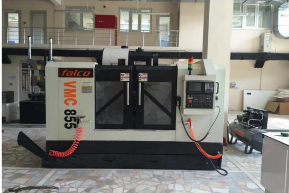
Şekil 4.5. Deneylerin yapıldığı CNC dik işleme merkezinin genel görünümü (Falco VMC 855) [27].
