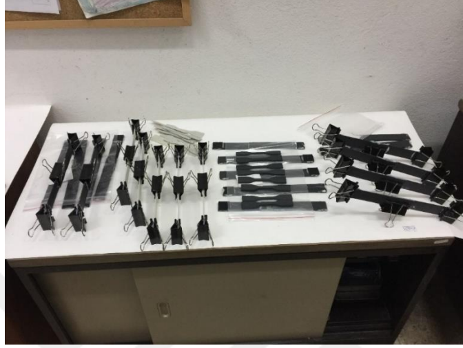
Şekil 6.16. Yapıştırırmalı bağlantılar ve çekme test numuneleri.
