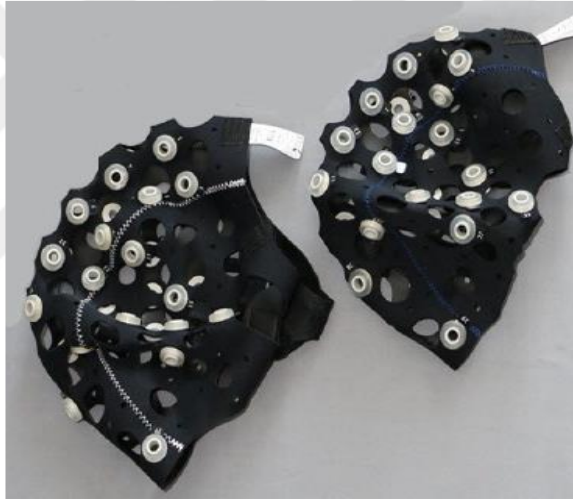
Şekil 5.5. Elektrotların kafa üzerinde istenen bölgede kalmasını sağlayan kep [43].
