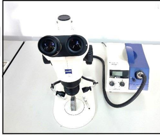
Şekil 5.8. ZEISS KL 1500 LCD mikroskop cihazı.
