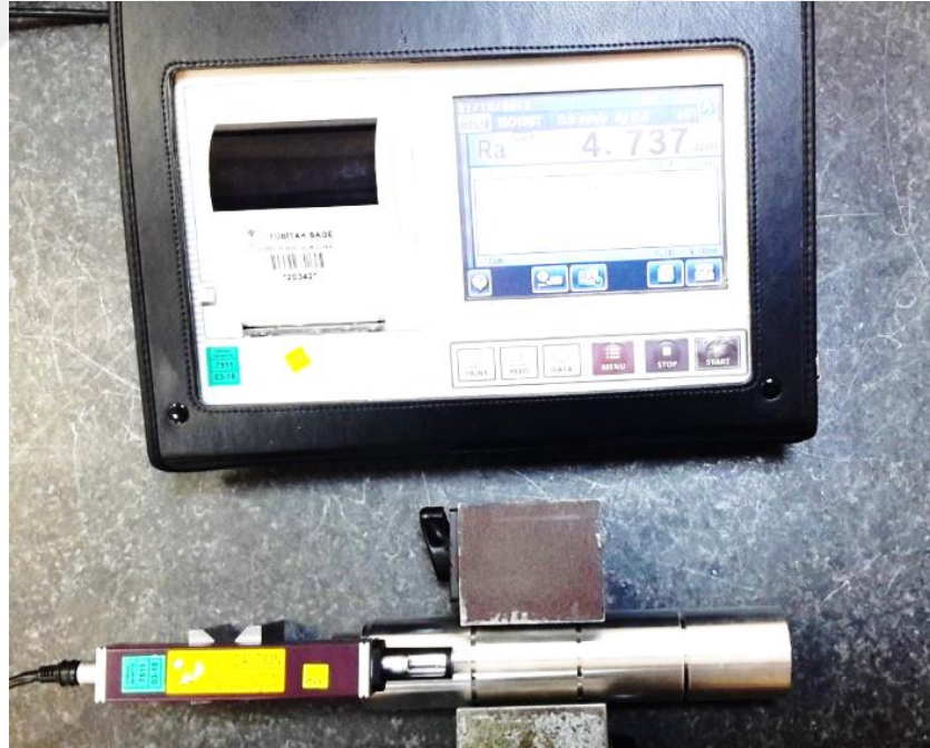
Şekil 5.7. Mitutoyo yüzey pürüzlülük cihazı.
