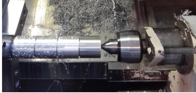
Şekil 5.12. Bir parçadan 4 deneş numunesi elde edilmesi.
