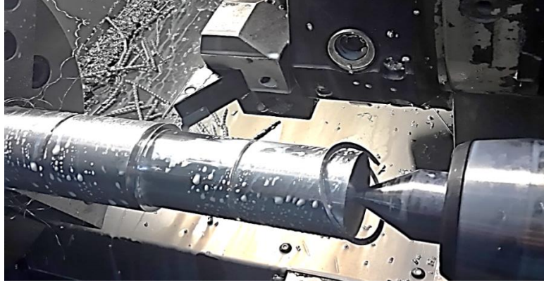
Şekil 5.13. Deney numunesinin işlenmesi aşaması.
