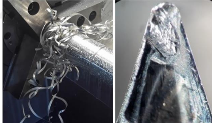
Şekil 6.7. Talaş sarması ve BUE oluşumu.
