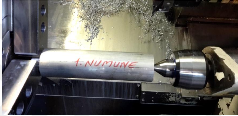
Şekil 5.11. Deneş numunesinin CNC tornaya bağlanması.
