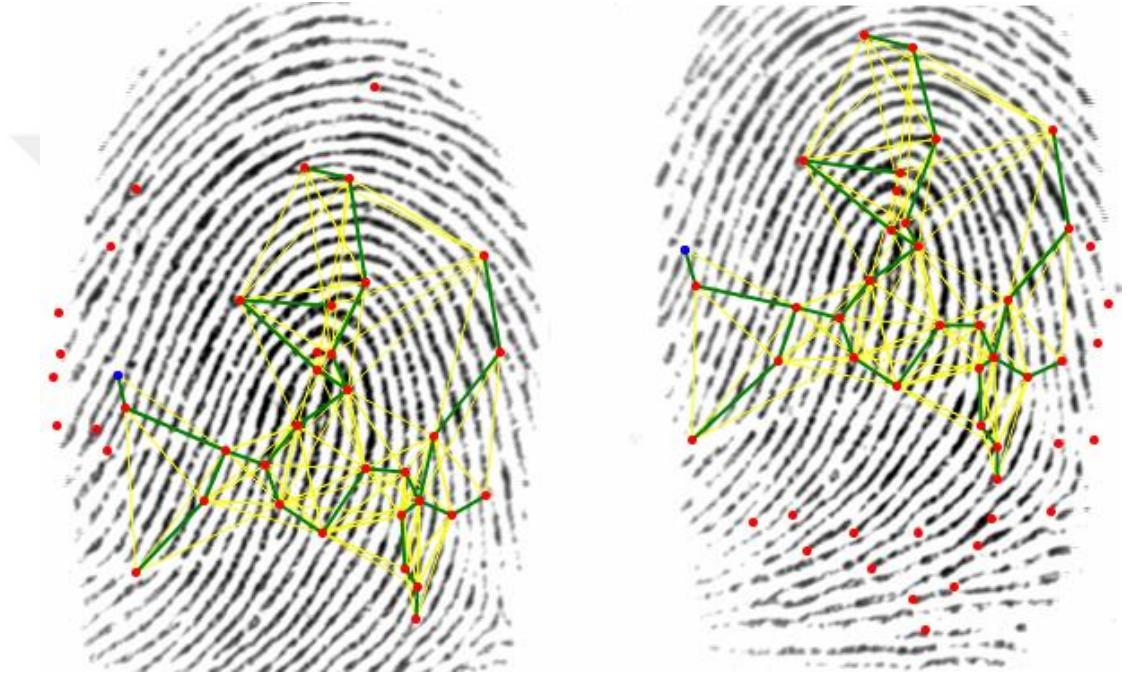
Şekil 3.6. Parmak izi görüntülerinin özellik noktalarının eşleştirilmesi [13].
