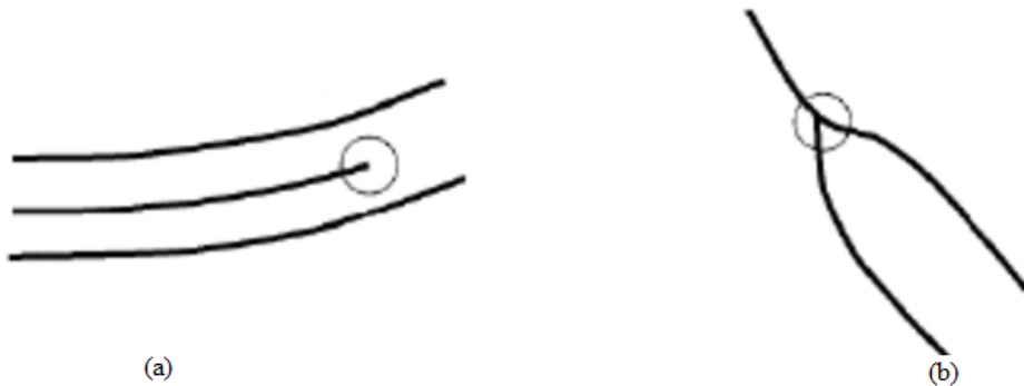
Şekil 3.1. a) Parmak izi sonlanma özellik noktası, b) parmak izi çatallanma özellik noktası.
