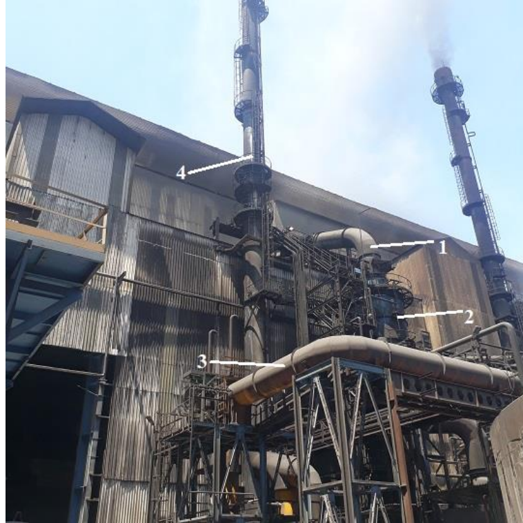
Şekil 4.1. KARDEMİR A.Ş çelik üretim tesisinde 3 numaralı BOF, BOF gazı taşıma sistemi genel görüntüsü.
