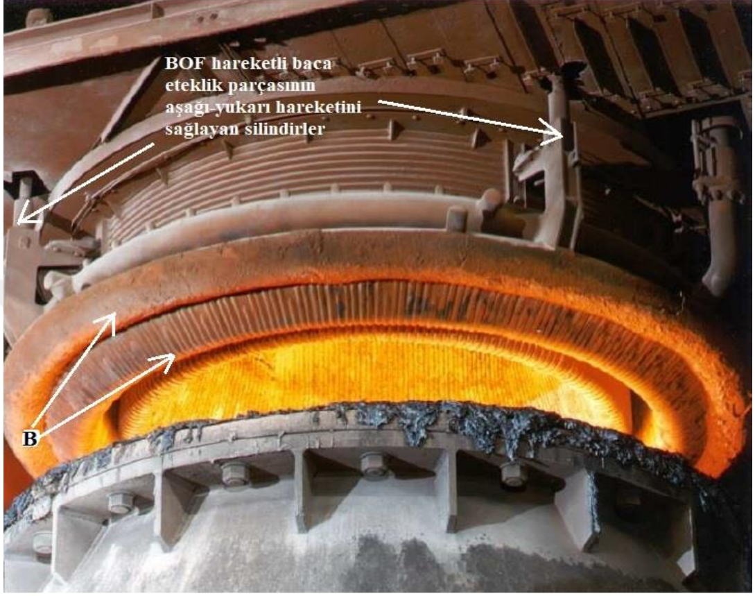
Şekil 2.5. BOF ağız ve alçaltılabilir eteklik görüntüsü [6].
