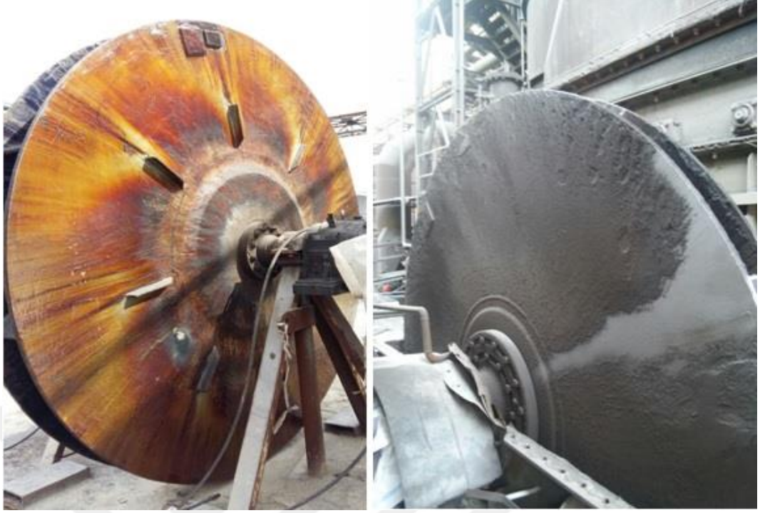
Şekil 4.5. Kardemir A.Ş Çelik üretim tesisine ait ID fanda oluşan a) Aşınma, kirlilik ve kullanım dışı kalan yüzeyinde oluşan asidik görüntüler b) Tesis duruşunda temizlenen ID fan görüntüsü.
