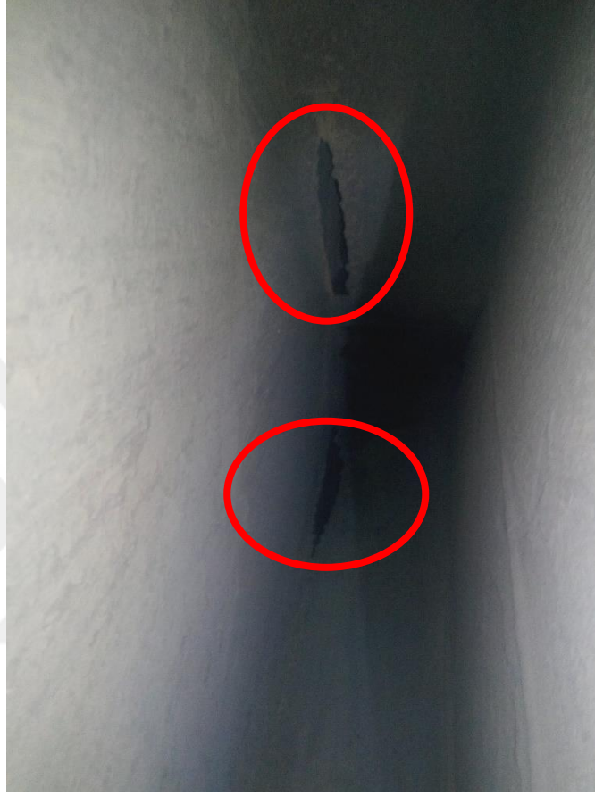
Şekil 5.6. Erozif ve korozif aşınma mekanizmaları kaynaklı ID fan kanatlarında oluşan aşınma görüntüleri.
