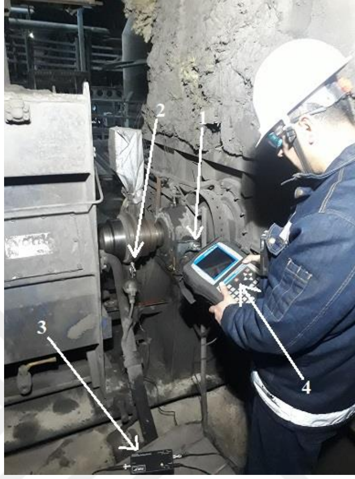
Şekil 5.1. Kardemir A.Ş çelik üretim müdürlüğünde kullanılmakta olan ID fan ekipmanında yapılan balans giderme işlemine ait görüntü.
