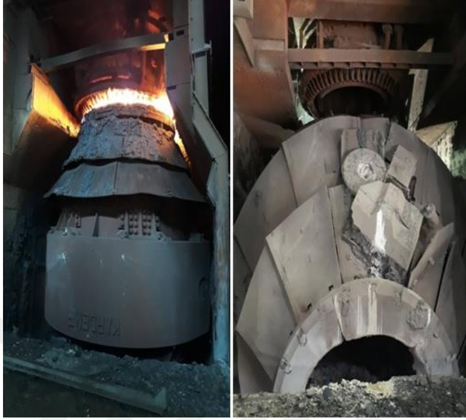
Şekil 2.1. İçerisi refrakter tuğla ile örülmüş BOF a) BOF içerisine oksijen üfleme anı görüntüsü, b) BOF' un bakım için duruş anı görüntüsü.
