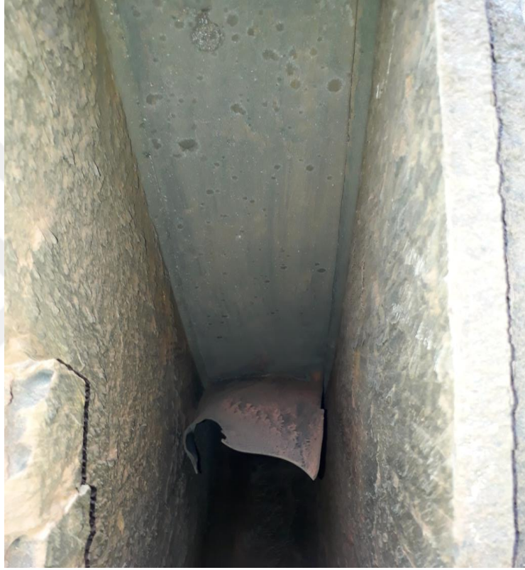
Şekil 4.9. S690QL yüksek mukavemetli çelikten yapılmış ID fan kanat üzerine yapılan AISI 304L kaplama malzemesinin deforme olmuş görüntüsü.
