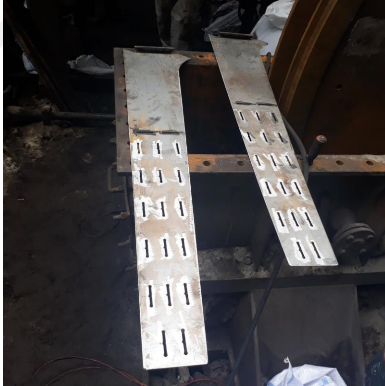
Şekil 4.8. AISI 304L paslanmaz çelikten yapımı gerçekleştirilen ID fan kanat görüntüsü.
