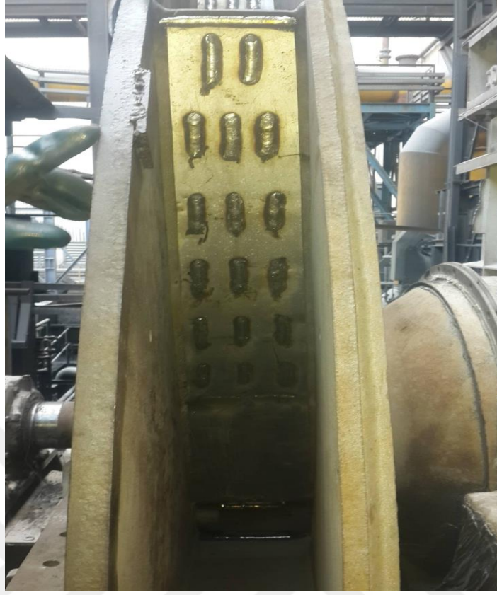
Şekil 4.10. ID fan kanat kaplama sacı üzerine çoklu kaynak deliği açılarak kaynak yapılan AISI 304L kaplama malzemesi görüntüsü.
