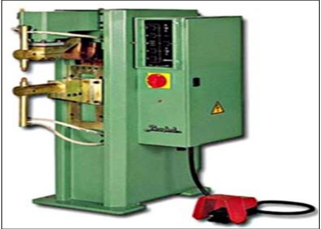
Şekil 5.2. Kullanılan Elektrik Direnç Nokta Kaynak Makinesi.
