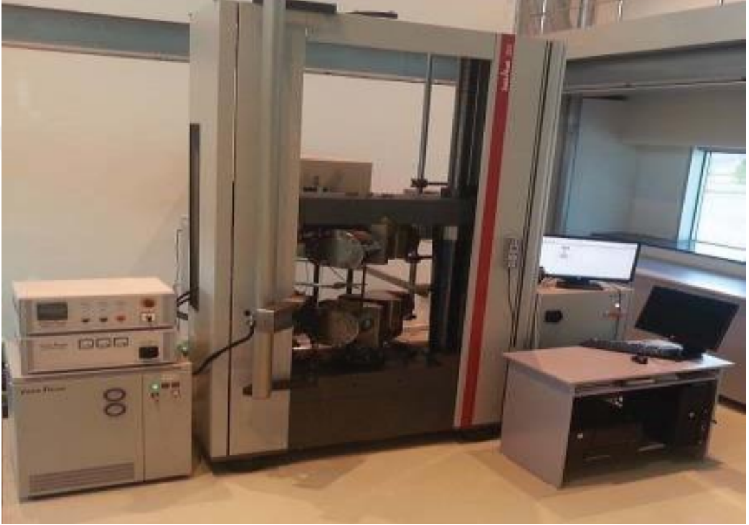
Şekil 5.6. Çekme test cihazı ve donanımı.
