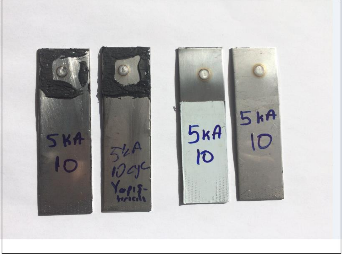
Şekil 6.7. 5 kA kaynak akımında 10 periyot kaynak zamanında oluşan yapıştırıcı ve yapıştırıcısız ayrılma tipi kopma görüntüleri.
