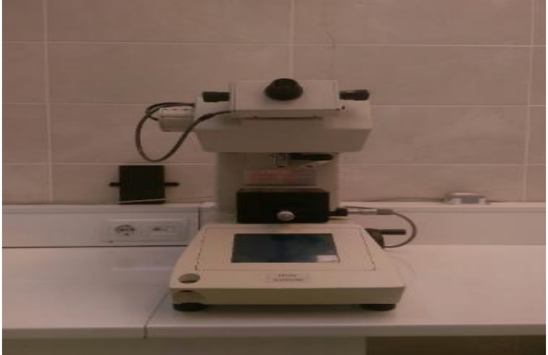
Şekil 5.8. Mikrosertlik ölçümünde kullanılan ölçüm cihazı.
