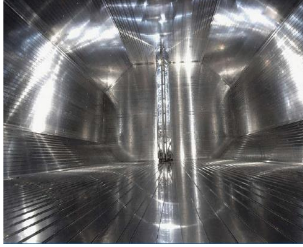
Şekil 2.12. Tankerin paslanmaz duvarlara sahip depolama tankı [26].
