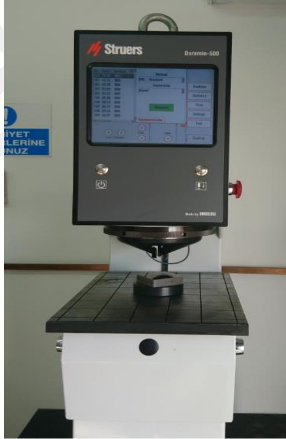
Şekil 4.9. Struers Duramin 500 sertlik ölçme cihazı.
