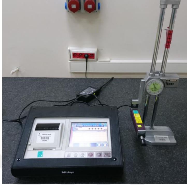
Şekil 4.8. MİTUTOYO SJ -310 yüzey kalitesi ölçüm cihazı.
