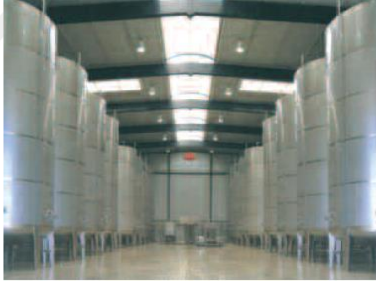
Şekil 2.20. Paslanmaz çelikten imal edilmiş süt tankları [35].
