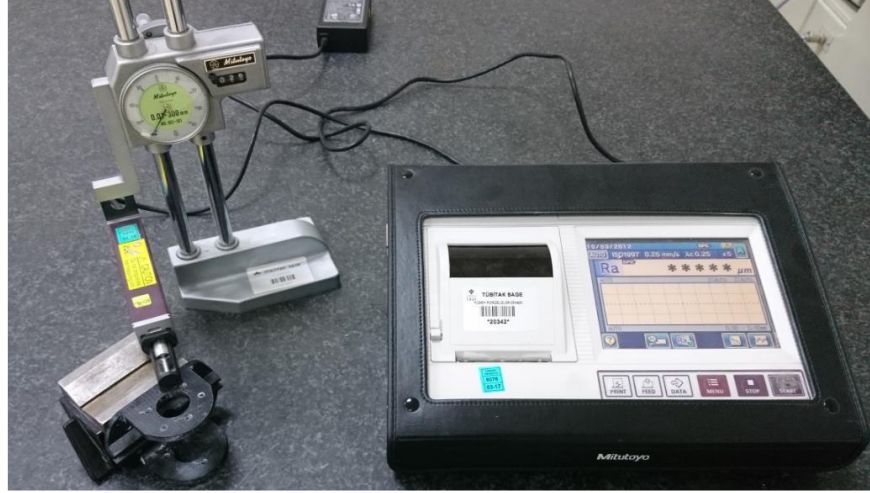
Şekil 7.21. MİTUTOYO SJ 310 cihazı.
