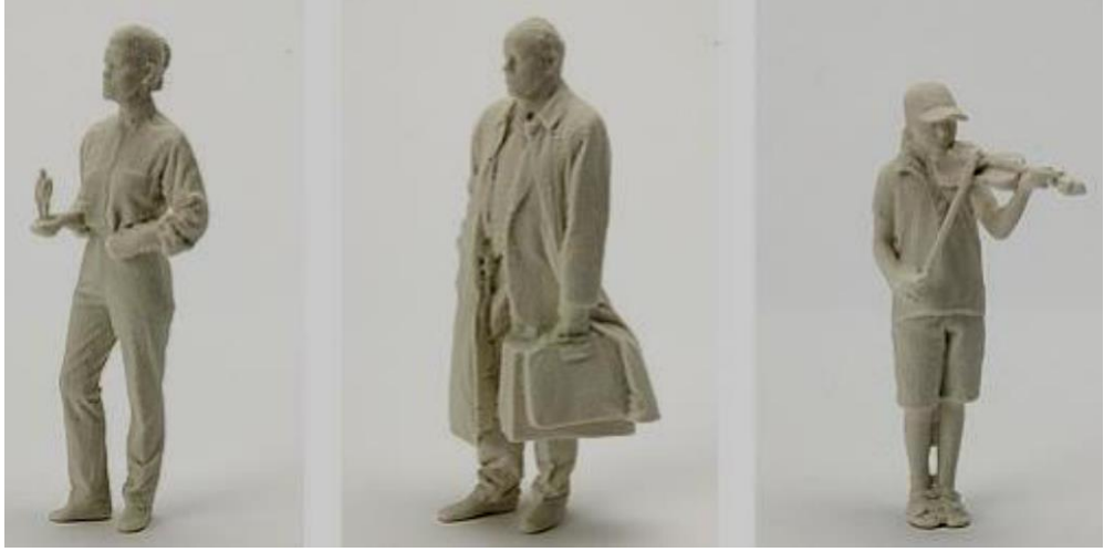
Şekil 4.14. Üç boyutlu tarama sistemi ve üç boyutlu yazıcılar yardımıyla insan figürlerinden oluşan heykeller [43].
