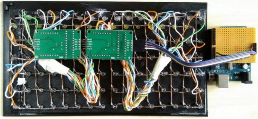
Şekil 4.17. Çağrı ve kabin hareketleri görüntüleme birimi devre resmi.
