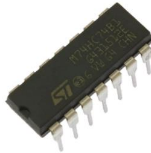
Şekil 4.4. 74HC74N entegresi ve bacak bağlantısı.
