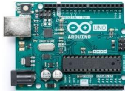
Şekil 4.15. Arduino Uno gömülü sistem geliştirme kartı [35].
