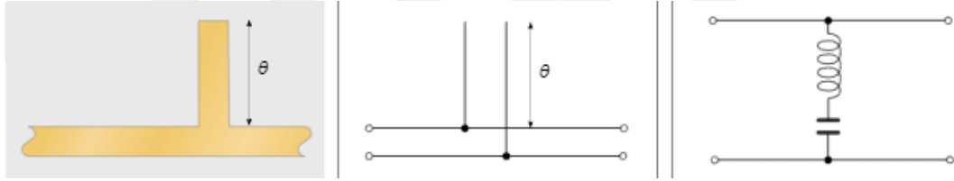
Şekil 3.16 Class J GY çıkış uyumlama devresi (stub filtre) tasarım B[21]
