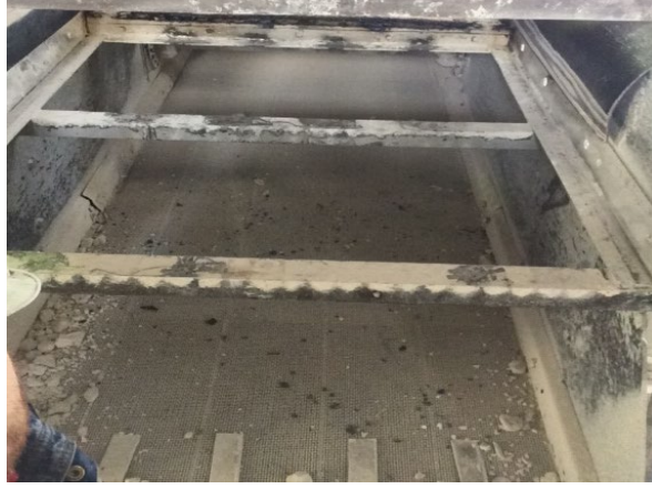
Şekil 6.6. Yanmış kireç taşı eleği üst kademe çelik esaslı elek panellerinin demonte edilmiş hali gösterimi.
