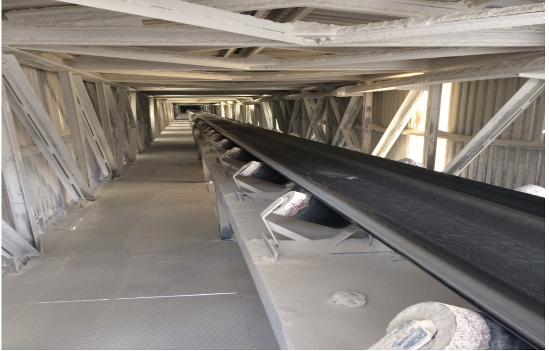
Şekil 3.16. Kireç fabrikalarından Çelikhaneye yanmış kireç taşı naklini gerçekleştiren bant yolu gösterimi.
