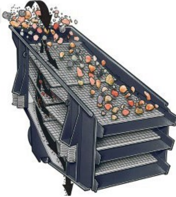
Şekil 6.2. Kademe sayısı 3 olan elek ile boyutlandırma işlemi anı görüntüsü [7].
