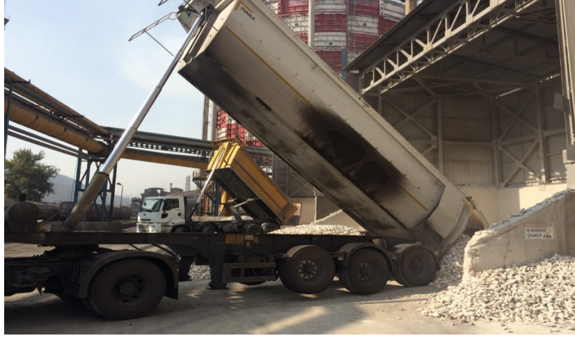
Şekil 3.2. Kireçtaşının damperli kamyonla yer altı bunkerlerine boşaltım anı görüntüsü.
