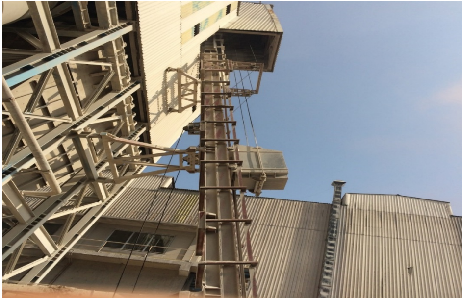
Şekil 3.6. Kireç taşı dolu skip arabasının eğik ray yolu üzerinde silo üstü bunkerine doğru hareketinin genel görünümü.
