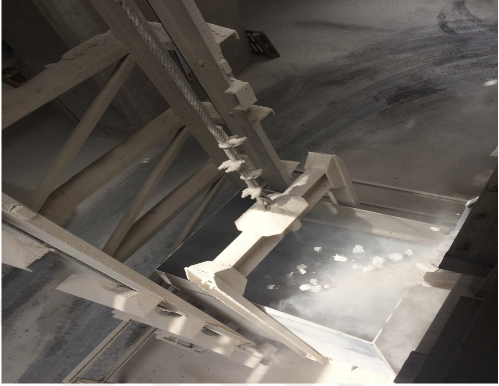
Şekil 3.10. Fırın skip arabasına kireç taşlarının boşaltım anı gösterimi.
