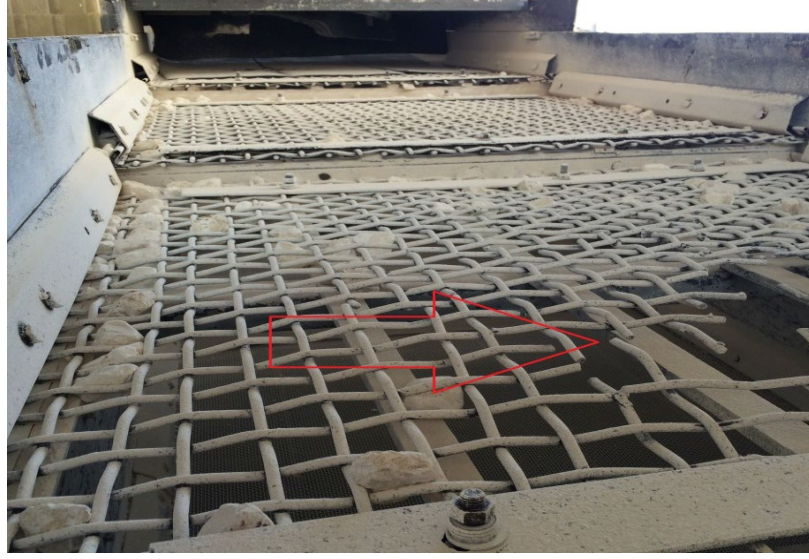
Şekil 4.3. Yanmış kireç taşı eleme esnasında çelik esaslı elek paneli üzerinde oluşan kopmaların gösterimi.
