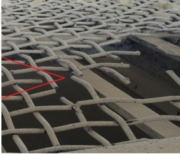
Şekil 6.3. Kardemir A.Ş yanmış kireç taşı eleğinin üst kademesinde bulunan çelik esaslı elek panellerinde oluşan kopmaların görünümü.
