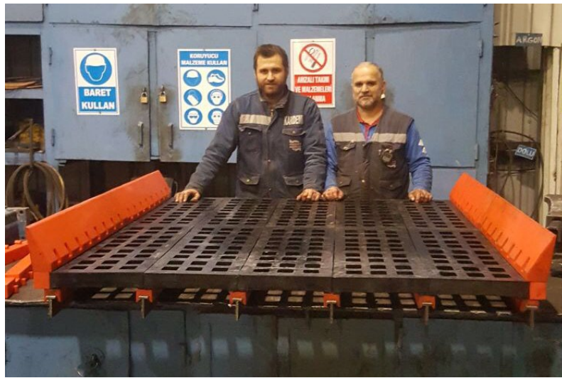
Şekil 4.7. Montaj için hazırlanmış kauçuk esaslı elek panelinin genel görünümü.
