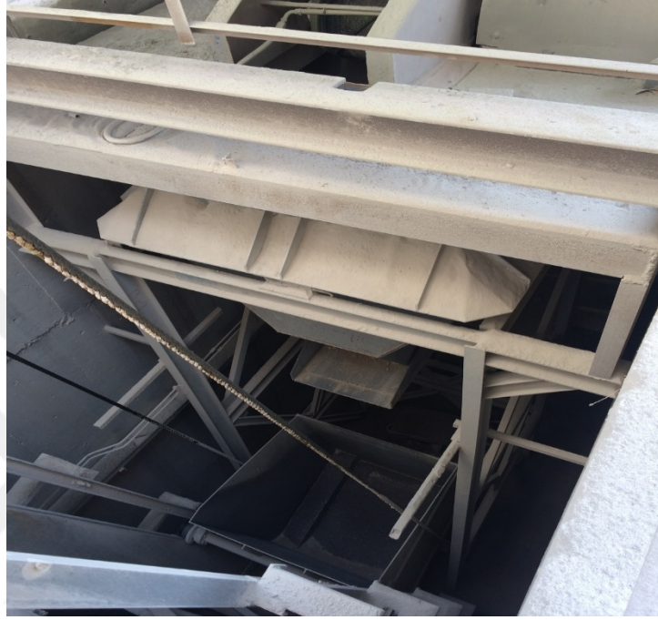
Şekil 3.5. Tartım bunkerini ve skip arabasını genel görünümü.
