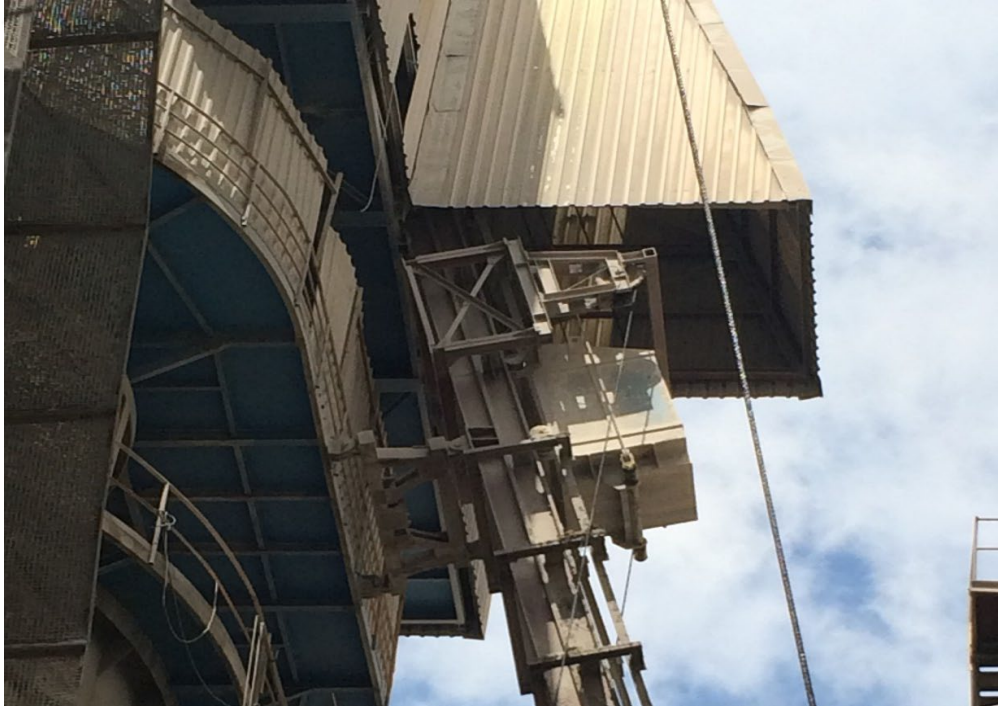
Şekil 3.11. Fırın skip arabasının fırın tepesine doğru hareketinin gösterimi.
