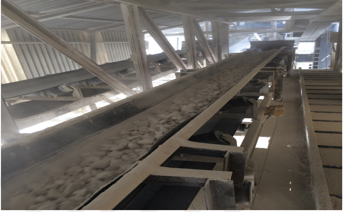
Şekil 3.15. Yanmış kireç taşlarının elevatöre bant yolu ile şarjının gösterimi.
