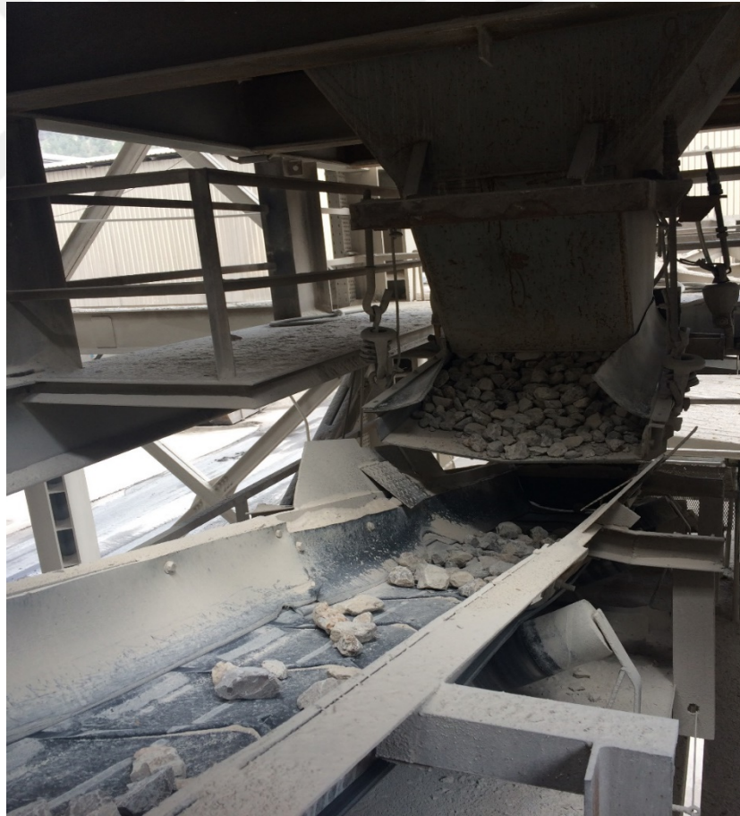
Şekil 3.9. Kireçtaşı silosundan bant yoluna kireç taşlarının boşaltımı ve kireç taşlarının bant yolu üzerindeki hareketinin gösterimi.
