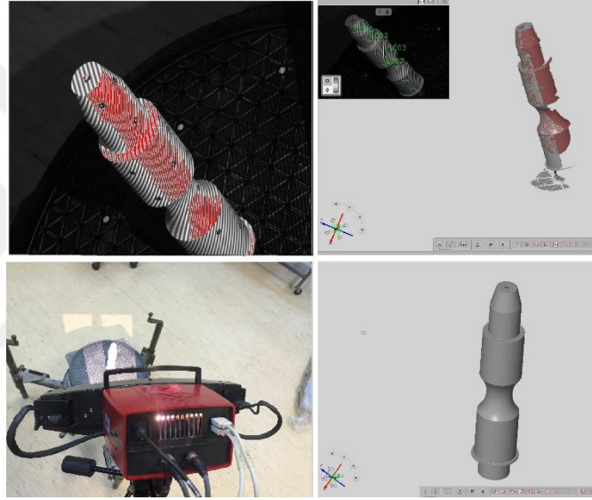
řekil 6.12. Ölçüm numunesine optik tarama uygulanması.
