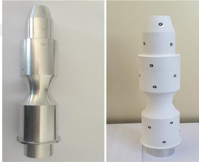
Şekil 6.11. Deney numunesine yapılan marker ve spreyleme işlemi.
