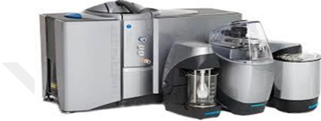
Şekil 5.2. Malvern Mastersizer 3000 toz boyutu ölçüm cihazı.
