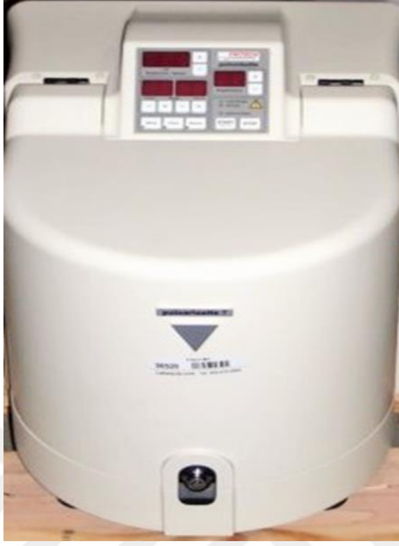
Şekil 5.1. Fritsch Pulverisette marka MA cihazı.
