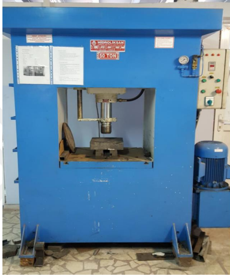
Şekil 5.4. Numunelerin şekillendirilmesinde kullanılan hidrolik pres.
