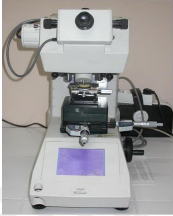
Şekil 5.8. Shimadzu marka mikro sertlik ölçüm cihazı.
