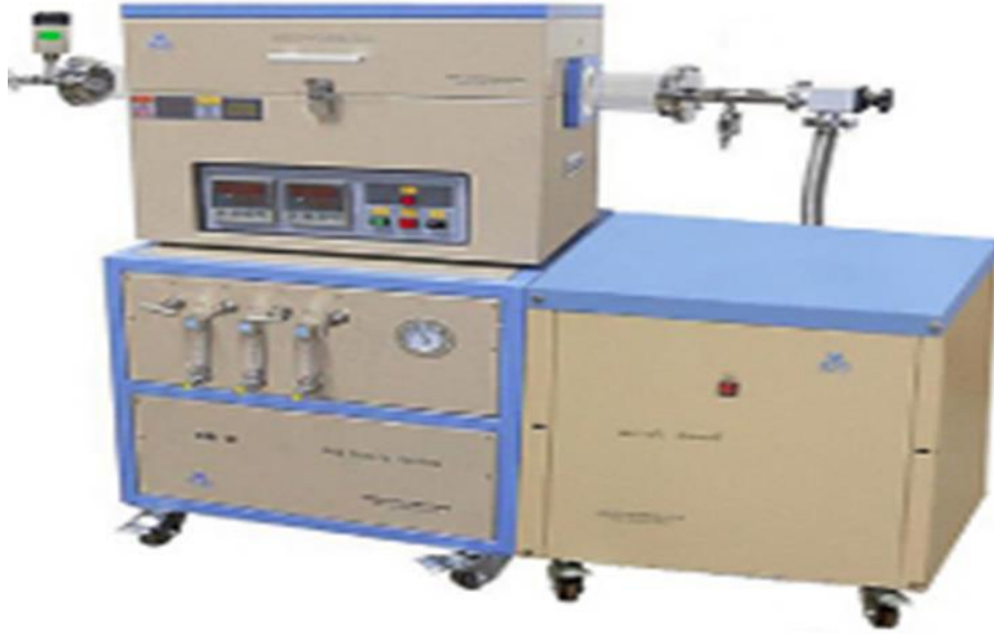
Şekil 5.5. Sinterleme işlemlerinin yapıldığı vakumlu ısıtım fırını.
