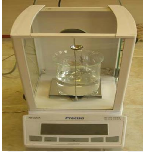
Şekil 5.7. PRECISA XB200 marka yoğunluk ölçme cihazı.
