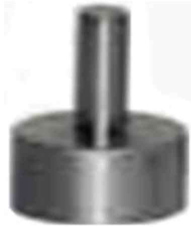
Şekil 5.3. Numunelerin şekillendirilmesinde kullanılan metal kalıp.
